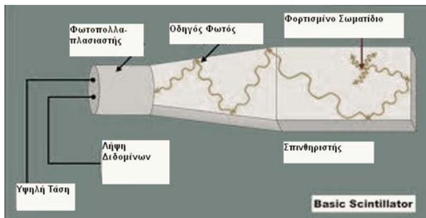
Σχήμα Γ2-2 Ανιχνευτής από πλαστικό σπινθηριστή.
