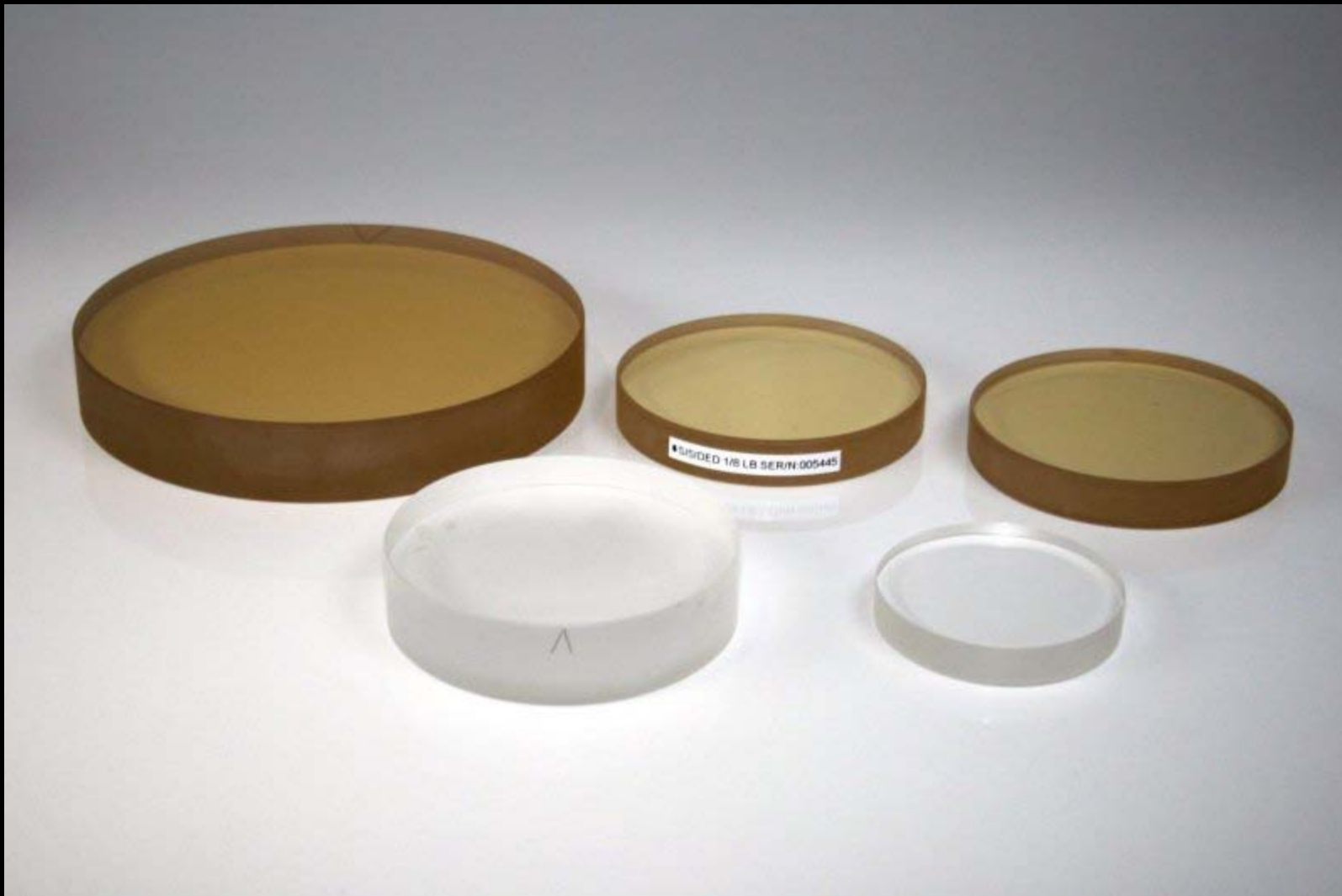
Ράβδοι υαλοκεραμικού υλικού ZERODUR και QUARZ
