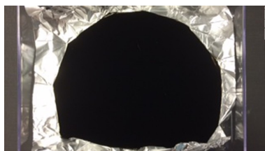
Σχήμα 1.10: Το υλικό Vantablack κατασκευασμένο από νανοσωλήνες άνθρακα (Surrey NanoSystems) το οποίο κατά τους κατασκευαστές απορροφά 99.96% του προσπίπτοντος σε αυτό φωτός. Εδώ επάνω σε φύλλο αργιλίου.
