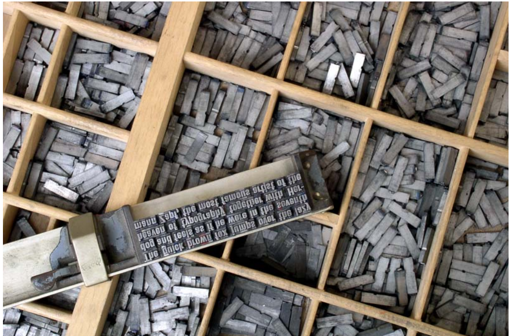
Εικόνα 8.20. Παραδοσιακή τυπογραφική στοιχειοθεσία με το χέρι. Κάσα με μεταλλικά τυπογραφικά στοιχεία και συνθετήριο όπου ο στοιχειοθέτης σχηματίζει αράδες με ανεστραμμένα γράμματα. 60
