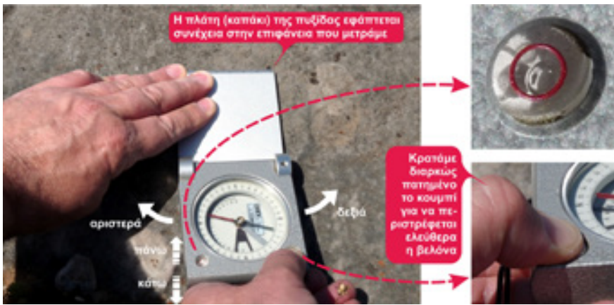
Εικόνα 4.8 Η σωστή τοποθέτηση της γεωλογικής πυξίδας και οι απαιτούμενοι (σωστοί) χειρισμοί για την πραγματοποίηση της μέτρησης των στοιχείων (τιμή κλίσης και φορά μέγιστης κλίσης) μιας γεωλογικής επιφάνειας (επιφάνεια στρώσης στην προκειμένη περίπτωση).
