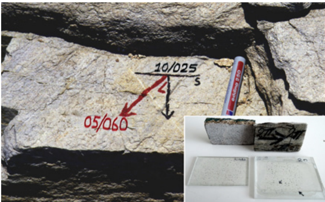
Εικόνα 11.4 Φύλλωση (Σχιστότητα S ) και γράμμωση έκτασης ( L ) σε μεταμορφωμένο γνευσιακό πέτρωμα. Το δείγμα είναι προσανατολισμένο και οι λεπτές τομές στο ένθετο (διαστάσεις ~2,5x3,5εκ.) έχουν γίνει παράλληλα και κάθετα με τη διεύθυνση της γράμμωσης και εγκάρσια στη φύλλωση.
