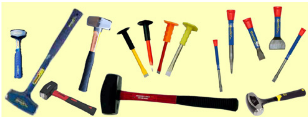
Εικόνα 2.2 Βαριοπούλες, σε διάφορα μεγέθη και βάρη, και καλέμια, σε διάφορους τύπους και μήκη (με μυτερή –pick ή φαρδιά –chisel απόληξη), συμπληρώνουν τα «σιδηρικά», που απαιτεί η λήψη δειγμάτων από σκληρά και «ζόρικα» πετρώματα. Η ύπαρξη προστατευτικής λαβής στο καλέμι, θα μας γλυτώσει από τις μελανιές και τον πόνο στο χέρι.
