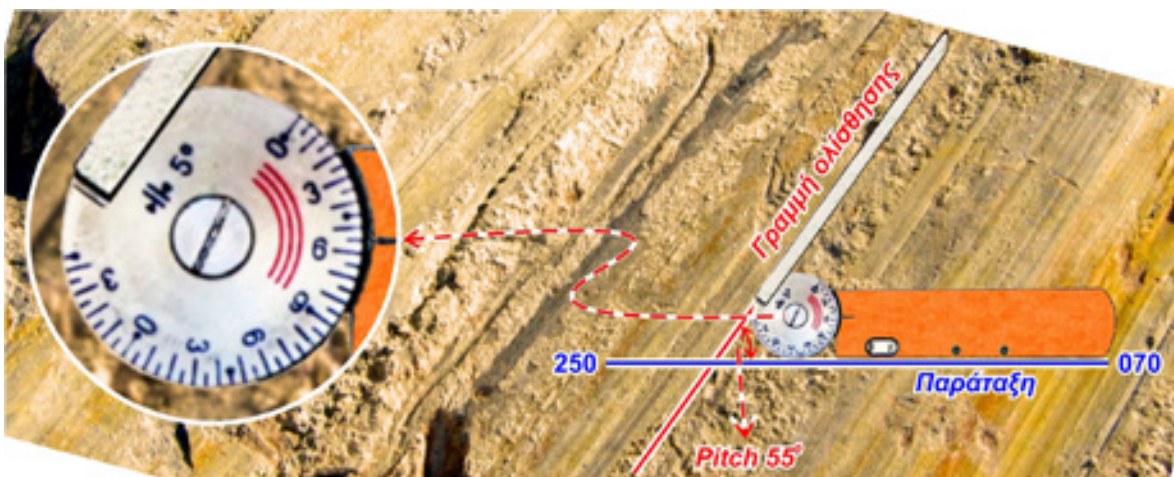
Εικόνα 4.15 Για να μετρήσουμε το pitch των γραμμών ολίσθησης τοποθετούμε το κυρίως σώμα της πυξίδας παράλληλα με την παράταξη της κατοπτρικής επιφάνειας και περιστρέφουμε το καπάκι μέχρι να γίνει παράλληλο με τη γραμμή ολίσθησης. Διαβάζουμε την τιμή στο πλαϊνό κλισίμετρο. Όπως φαίνεται το pitch είναι 55°, από τα ENE (070).
