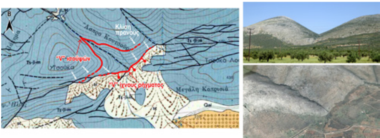
Εικόνα 7.10. Εφαρμογή του κανόνα του "V". Στην προκειμένη περίπτωση το "V" των ισοϋψών είναι αντίθετο από αυτό του ίχνους του ρήγματος. Άρα η κλίση του ρήγματος είναι ομόρροπη με την κλίση του πρηνούς. Δηλαδή το ρήγμα κλίνει προς τα ΝΝΑ και άρα πρόκειται για κανονικό ρήγμα. Το απόσπασμα του γεωλογικού χάρτη του ΙΓΜΕ είναι από το φύλλο «Βάγια» (Τάταρης κ.ά., 1970). Στις διπλανές φωτογραφίες (η κάτω από το Google Earth) φαίνεται η μορφολογία του πρηνούς και η γεωμετρία του ίχνους του ρήγματος.
