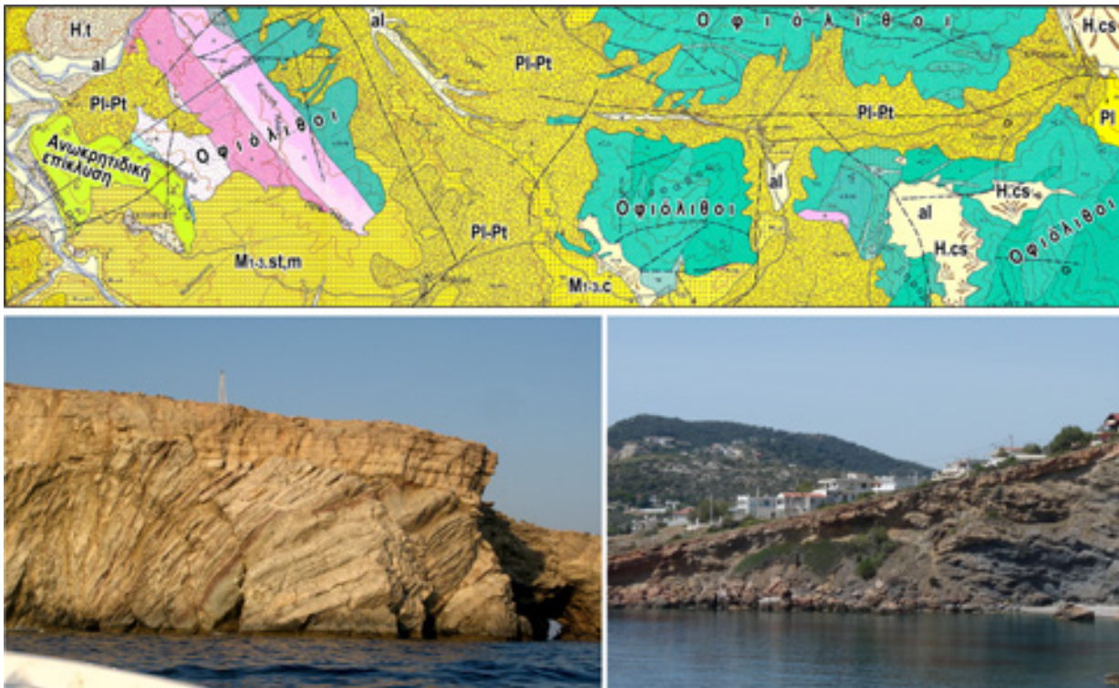
Εικόνα 7.5. Στην επάνω εικόνα (από το φύλλο «Κνίδη» του ΙΓΜΕ), η χαρτογραφική απεικόνιση της κλασικής ορογενετικής ασυμφωνίας στις Ελληνίδες, με το στρωματογραφικό κενό να καλύπτει όλη την αλπική ορογένεση, αντιπροσωπεύεται από την ασύμφωνη απόθεση των μολασσοικών και νεογενών σχηματισμών, αλλά και των τεταρτογενών αποθέσεων στο αλπικό υπόβαθρο. Στην κάτω αριστερή φωτογραφία από τη Νήσο Γαύδο, ασύμφωνη απόθεση, σχεδόν οριζόντιων, νεογενών στρωμάτων, σε ανορθωμένα λεπτοπλακώδη ιζήματα της ενότητας της Πίνδου (φωτογραφία του αγαπητού συνάδελφου Απόστολου Αλεξόπουλου). Στην κάτω δεξιά φωτογραφία ασύμφωνη απόθεση κώνου κορημάτων σε κεκλιμένα σχιστολιθικά πετρώματα (από την παραλιακή ζώνη της Κακής Θάλασσας, ανατολικά της Κερατέας στην Αττική).
