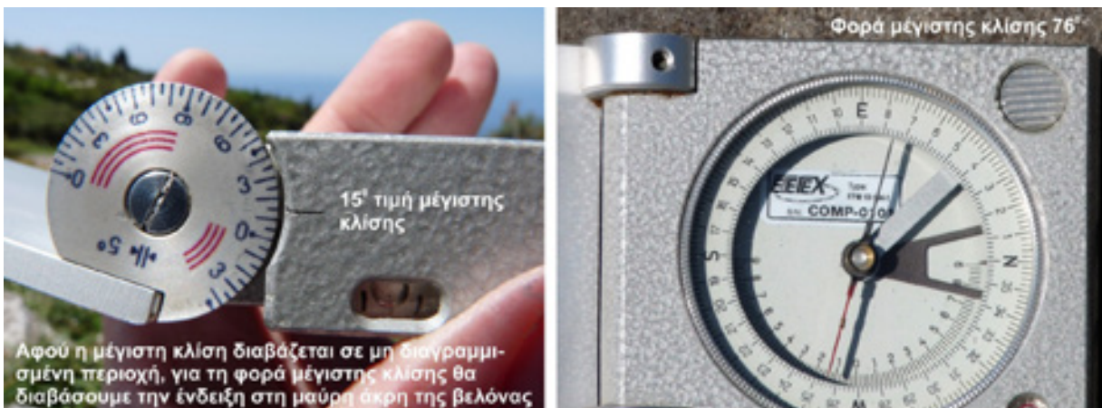
Εικόνα 4.9 Διαβάζοντας σωστά την τιμή της κλίσης (15°, σε μη διαγραμμισμένη κόκκινη περιοχή) και τη φορά μέγιστης κλίσης (076, αφού πρέπει να διαβάσω την ένδειξη στη μαύρη άκρη της μαγνητικής βελόνας).
