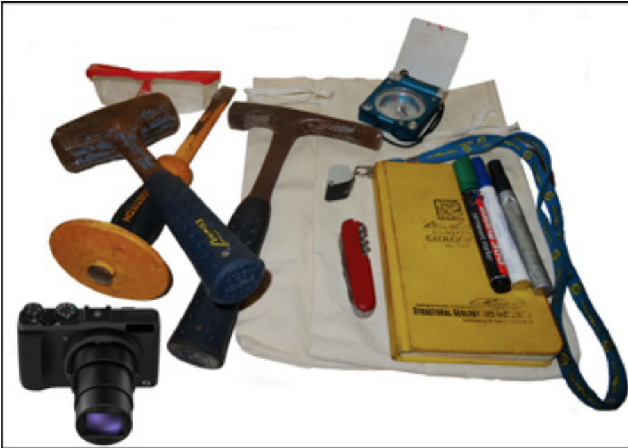
Εικόνα 11.2 Ο ελάχιστος απαιτούμενος εξοπλισμός για τη συλλογή δειγμάτων σε μία βασική γεωλογική χαρτογράφηση αλλά και σε αρκετές πιο εξειδικευμένες χαρτογραφήσεις. Η φωτογραφία έχει ληφθεί από φωτογραφική μηχανή με GPS.
