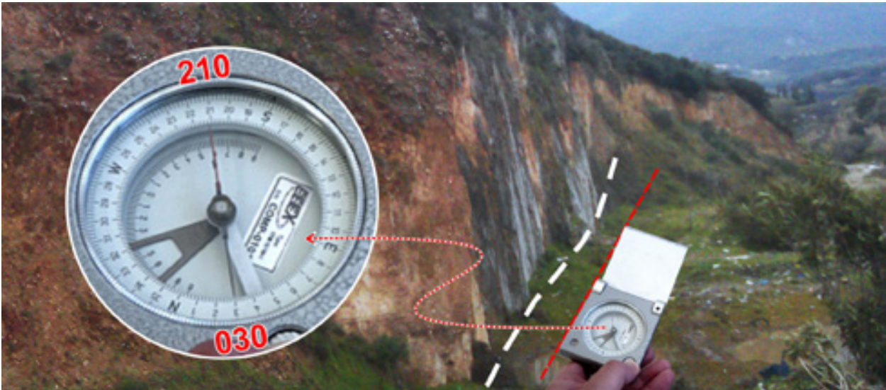
Εικόνα 4.24 Μετρώντας από μακριά τη διεύθυνση του ίχνους ενός ρήγματος, που είναι υπεύθυνο και για το μορφολογικό μέτωπο που έχει δημιουργηθεί. Παραλληλίζουμε την πλαϊνή ακμή της πυξίδας με το ίχνος του μετώπου (και του ρήγματος), έχοντας απελευθερωμένη τη βελόνα και προσέχοντας το σώμα της πυξίδας να είναι οριζόντιο. Στη συνέχεια διαβάζουμε τις δύο αντιδιαμετρικές τιμές που δείχνουν οι άκρες τις βελόνας στον δακτύλιο της πυξίδας (οι ενδείξεις στη Freiberg πολλαπλασιάζονται επί 10). Για το παράδειγμά μας η διεύθυνση είναι 030–210, ή N30°E.
