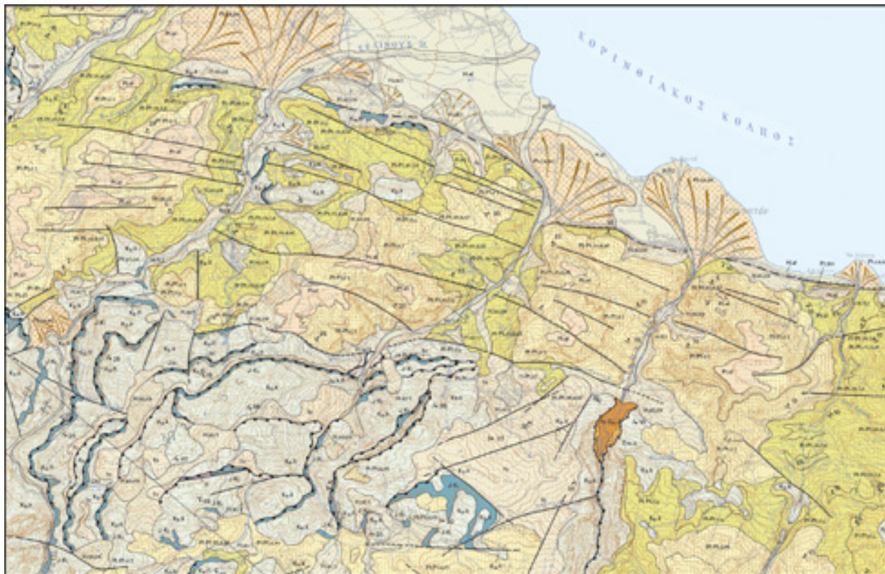
Εικόνα 7.6. Χαρτογραφική απεικόνιση επωθητικών και κανονικών ρηγμάτων. Τα επωθητικά ρήγματα εντοπίζονται στο νότιο τμήμα του χάρτη και αφορούν παλιές αλπικές δομές στο σύστημα πτυχών-επωθήσεων της ενότητας Ωλωνού-Πίνδου. Τα κανονικά ρήγματα σχετίζονται με την εξέλιξη του νότιου περιθωρίου του Κορινθιακού κόλπου και αντιπροσωπεύουν νεοτεκτονικά ρήγματα, από τα οποία αυτά που σήμερα χαρακτηρίζονται ως ενεργά και σεισμικά εντοπίζονται στον υποθαλάσσιο χώρο και την παραλιακή ζώνη της Β. Πελοποννήσου. Απόσπασμα από το γεωλογικό χάρτη του ΙΓΜΕ, φύλλο «Αίγιο» (Τσόφλιας, 2005).
