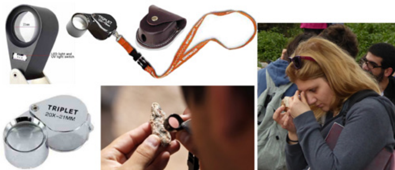
Εικόνα 2.5 Μια αναδιπλούμενη λούπα (folding magnifier), απλή ή με φωτισμό και μεγέθυνση της τάξης 10x έως 20x, είναι απαραίτητη για την αναγνώριση μικροαπολιθωμάτων και ορυκτών στα πετρώματα. Η τεχνική προϋποθέτει να πλησιάσουμε τη λούπα και το δείγμα του πετρώματος προς το μάτι μας, μέχρι να εστιάσει η εικόνα. Ένα κορδόνι, για να την έχουμε πάντα περασμένη στο λαιμό μας, είναι η πιο ασφαλής και βολική λύση. Αν υπάρχει και θήκη ακόμα καλύτερα για την προστασία του φακού.
