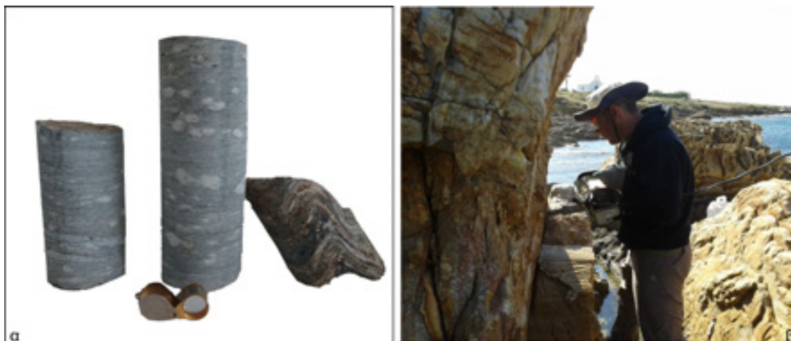
Εικόνα 11.6 α) Καρότα γεωτρήσεων που έχουν ληφθεί από μολονιτικούς γενέσιους και σχιστόλιθους. β) Εξαγωγή δείγματος για παλαιομαγνητική ανάλυση με φορητό γεωτρήπανο.
