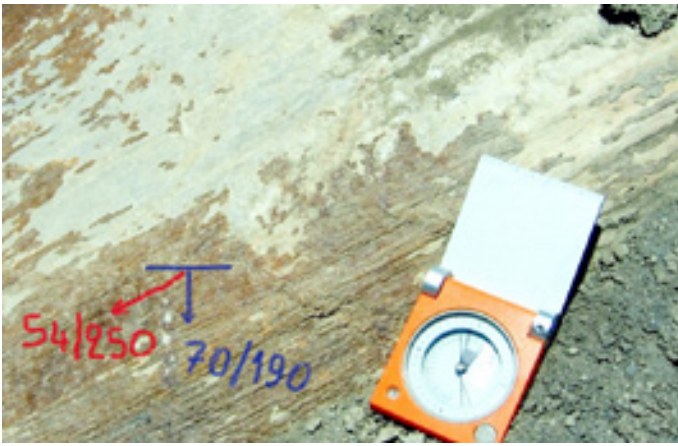
Εικόνα 4.14 Συνδυασμένη αποτύπωση πάνω στην κατοπτρική επιφάνεια του ρήγματος και των δύο μετρήσεων, της επιφάνειας και των γραμμών ολίσθησης. Με «κλικ» στο βιντεάκι, θα δείτε και θα μάθετε όλα τα «μυστικά».
