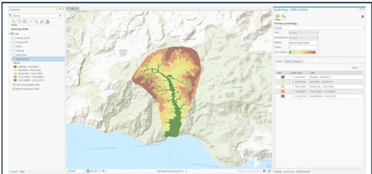
Εικ. 5.6: Θεματικός υψομετρικός χάρτης όπως προκύπτει από το DEM, επιλέγοντας 5 εύρη τιμών, ο χωρισμός των οποίων έγινε με τη μέθοδο Natural Breaks (Jenks).
