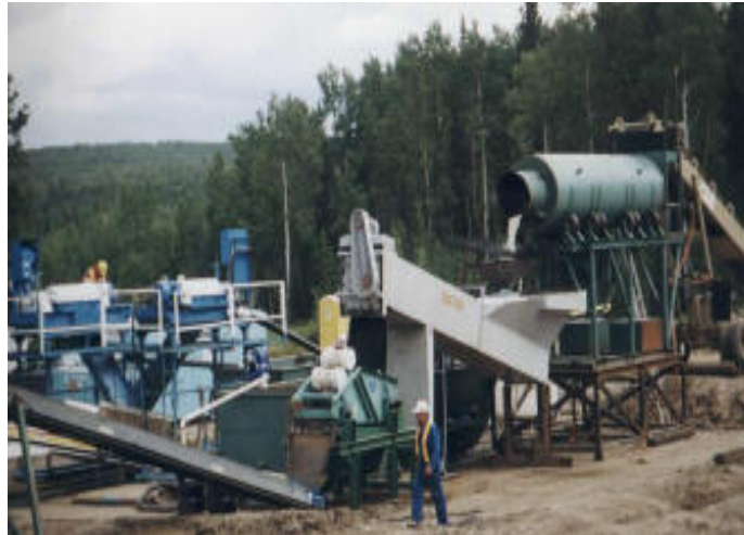
Εικόνα 5-1: Εξοπλισμός και τμήματα συστημάτων εδαφικής πλύσης on-site ( http://art-engineering.com ).
