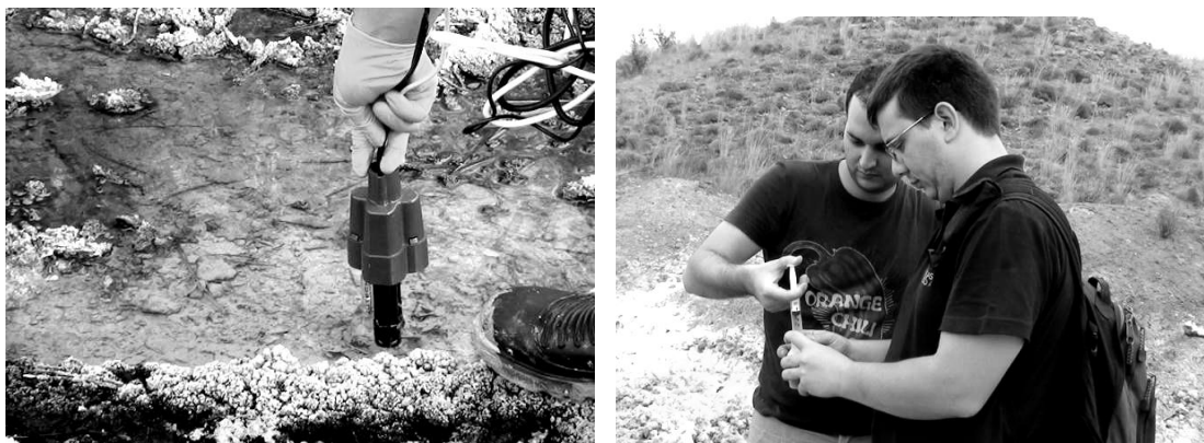
Εικόνα 2.7: Καταγραφή σημαντικών φυσικοχημικών παραμέτρων (αριστερά) και επί τόπου διήθηση (δεξιά) κατά τη συλλογή δειγμάτων νερού.
