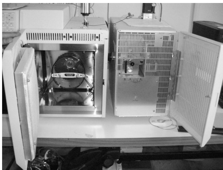
Εικόνα 5.1: Σύστημα GC-MS του Πανεπιστημίου Αθηνών. Στην κάτω φωτογραφία διακρίνεται η χρωματογραφική στήλη εντός του φούρνου στα αριστερά.
