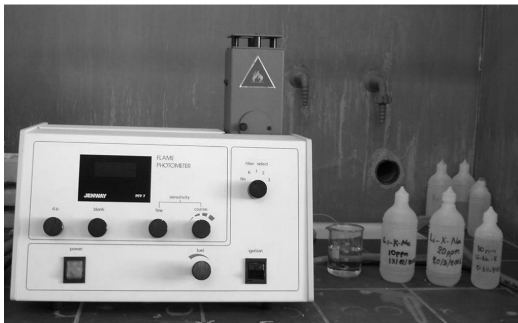
Εικόνα 3.9: Το όργανο φλογοφωτομετρίας ατομικής εκπομπής που χρησιμοποιείται στο Εργαστήριο Γεωχημείας για τον προσδιορισμό K και Na σε διαλύματα.
