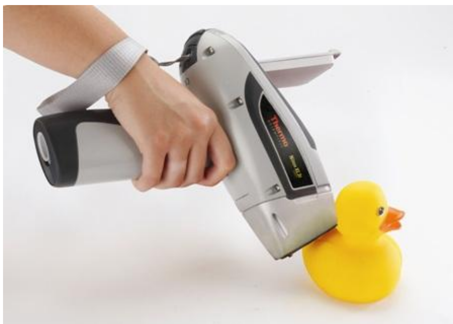
Εικόνα 4.5: Φορητό όργανο XRF το οποίο επιτρέπει την in situ μέτρηση συγκεντρώσεων στοιχείων σε ποικιλία υλικών.
