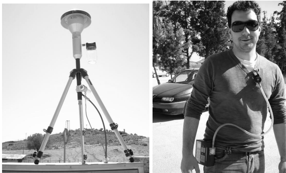
Εικόνα 2.8: Σύστημα αντλίας αέρα υψηλής παροχής (αριστερά) και χαμηλής παροχής με προσαρμοσμένο φίλτρο (δεξιά) για τη συλλογή αιωρούμενων σωματιδίων.
