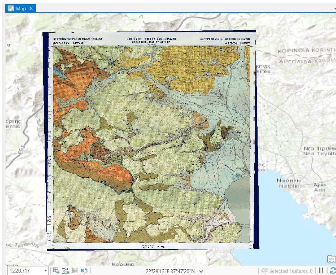
Εικ. 3.21: Ο χάρτης είναι γεωαναφερόμενος στο προβολικό σύστημα Greek Grid, παρόλο που στην παρούσα εικόνα εμφανίζεται σε GCS WGS 1984. Η αλλαγή αυτή όμως δεν είναι μόνιμη. Την επόμενη φορά που θα ενεργοποιήσετε και πάλι το επίπεδο πληροφορίας argos50000_Greek_Grid.tiff , θα είναι πάλι στο προβολικό σύστημα ΕΓΣΑ '87.
