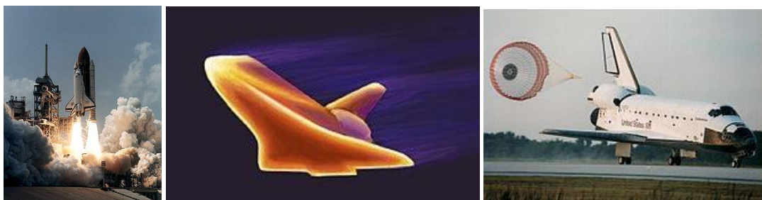
Σχήμα 19: Το διαστημικό λεωφορείο Atlantis εκτοξεύεται ξεκινώντας την αποστολή STS-71, Στις εξωτερικές επιφάνειες του σκάφους αναπτύσσονται θερμοκρασίες έως και 1.500°C κατά τη διάρκεια της επανεισόδου. Το Εντέβορ στη φάση της προσγείωσης και ενώ έχει ανοίξει το αλεξίπτωτο
