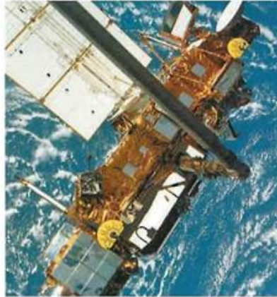
Σχήμα 202: Θερμική κουβέρτα προστασίας MLI στο εξωτερικό του Upper Atmospheric Research Satellite (UARS)
