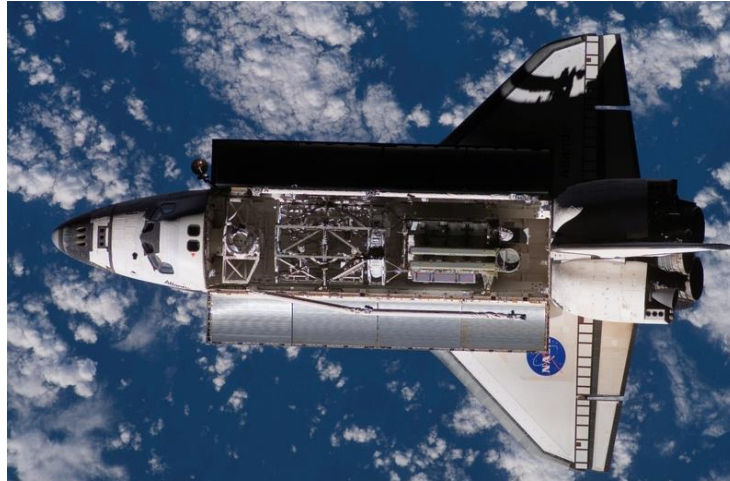
Σχήμα 203: Ακτινοβολητές (radiators) του Διαστημικού Λεωφορείου
