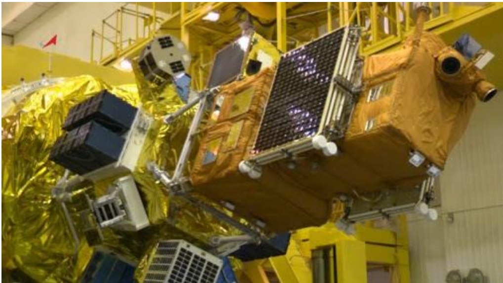
Σχήμα 139: Δορυφόροι προς εκτόξευση με τον φορέα Soyuz 2.1 (Ρωσία) το 2017. Μικροδορυφόροι είναι τοποθετημένοι κάτω από το πρωτεύον φορτίο (δορυφόρος τηλεπαρατήρησης Kanopus) ως δευτερεύοντα φορτία με χαμηλότερο κόστος εκτόξευσης. Το δευτερεύων φορτίο θα πάει υποχρεωτικά στην ίδια τροχιά με το πρωτεύον φορτίο.
