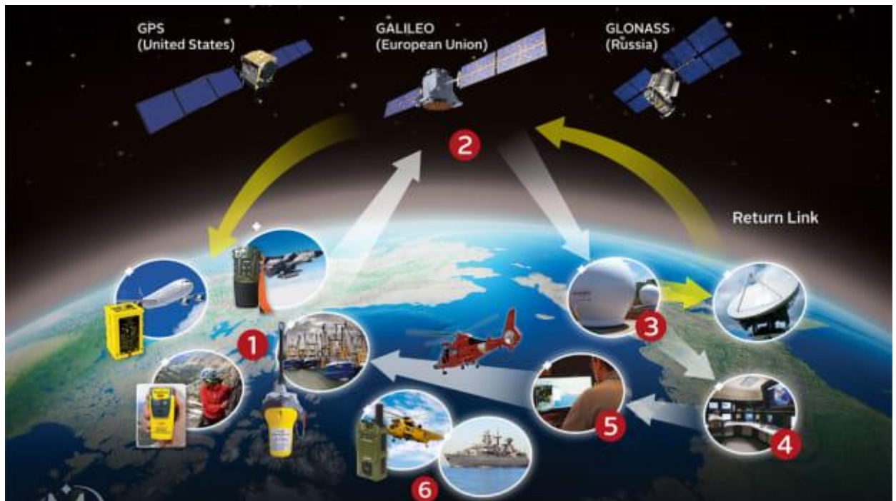
Σχήμα 38: Αρχιτεκτονική Λειτουργίας του Συστήματος Cospas-Sarsat
