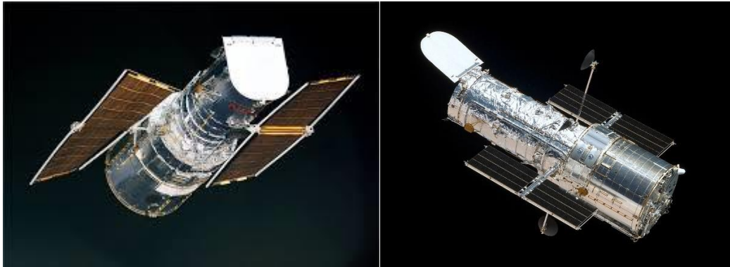
Σχήμα 161: (Αριστερά) Το διαστημικό τηλεσκόπιο Hubble με παραμορφωμένες ηλιακές συστοιχίες (Δεξιά) Νέες στιβαρές ηλιακές συστοιχίες που εγκαταστάθηκαν σε αποστολή του Διαστημική Λεωφορείου το 1993 και το 2002 1
