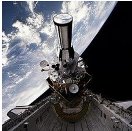
Σχήμα 205: Δορυφόρος DSP για την παρακολούθηση εκτοξεύσεων και μεγάλων εκρήξεων (Ασφάλεια). Χρησιμοποιεί αισθητήρες υπέρυθρων που απαιτούν ψύξη
