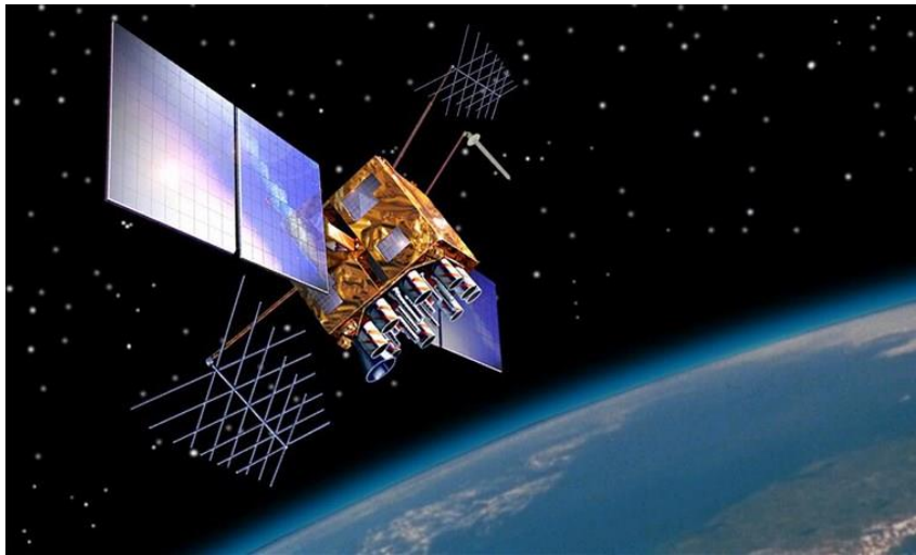
Σχήμα 141: Δορυφόρος GPS (ΗΠΑ). Οι απαιτήσεις και προδιαγραφές ισχύος, θερμικής προστασίας, τηλεπικοινωνίες/ζεύξεις όπως και η ανάγκη για πτυσσόμενες κεραιές επηρέασαν την συνολική σχεδίαση του διαστημικού σκάφους
