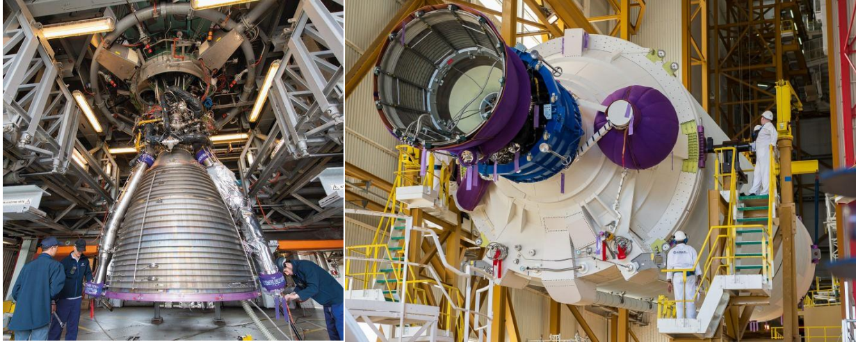
Σχήμα 145: Ο κινητήρας Vulcain του εκτοξευτή Ariane 5 ως κύριο μέρος του υποσυστήματος προώθησης
