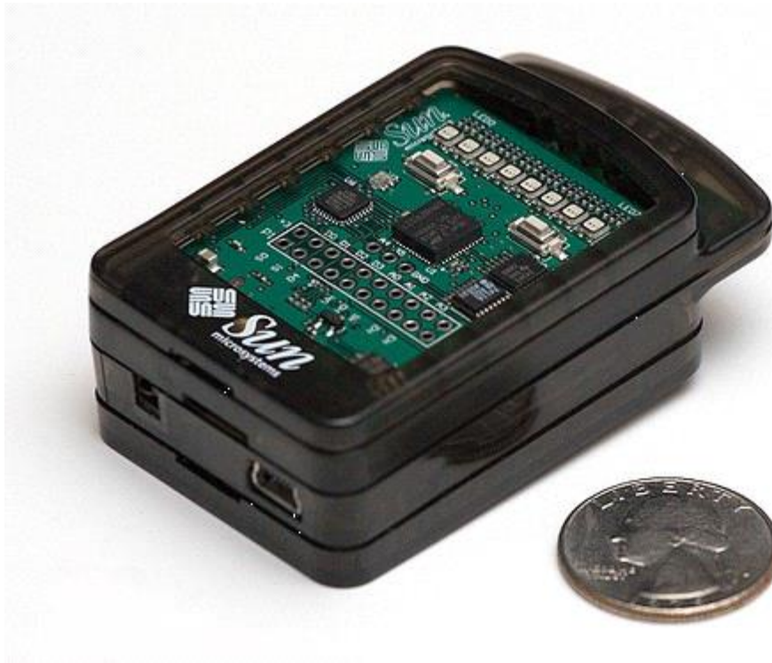
Εικόνα 2: Μία συσκευή SunSPOT
