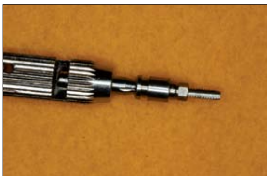
Εικόνες 23-24. Το ειδικό σετ για την αφαίρεση σπασμένων βιδών (Repair set, Friadent -Dentsply).
