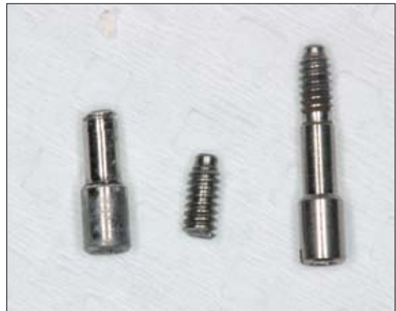
Εικόνες 21-22. Θραύση της βίδας στερέωσης στο στηρίγμα συγκολλούμενης γέφυρας.
