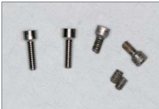
Εικόνες 1 και 2. Θραύση των βιδών στερέωσης σε κοχλιούμενες ενωμένες στεφάνες.
