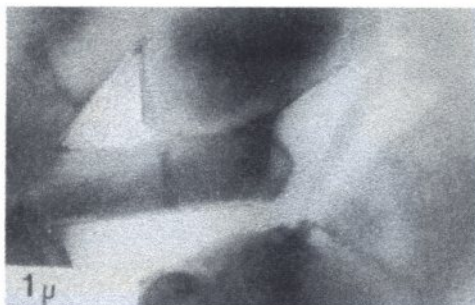
ΕΙΚΟΝΑ 3. Το φαινόμενο της περίτηξης. Οι κόκκοι συμπλησιάζουν πολύ μεταξύ τους, αφήνοντας πολύ μικρούς χώρους που θα καταληφθούν από την υαλική φάση (Vita Zahnfabrik, Bad Säckingen, Germany).
