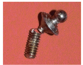
Εικ 16. Κάταγμα της βίδας του σφαιρικού συνδέσμου στον αυχένα.
