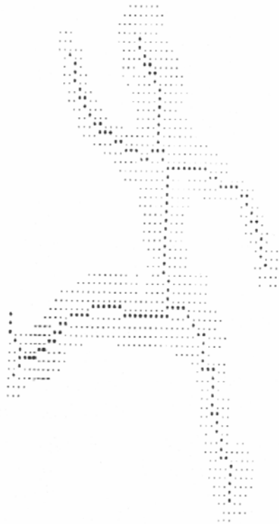
Σχήμα 7.19 Σκελετός αντικειμένου χρησιμοποιώντας τον αλγόριθμο του (Gonzalez 1997).
