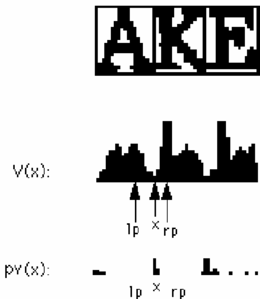
Σχήμα 6.12. Δημιουργία συνάρτησης λόγου κορυφής-κοιλιάδας (peak-to-valley ratio) από την κάθετη προβολή της περιοχής των ενωμένων χαρακτήρων.
