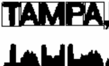
Σχήμα 6.7. Κάθετες προβολές σε γραμμή κειμένου που αποτελείται από επικαλυπτόμενους χαρακτήρες.
