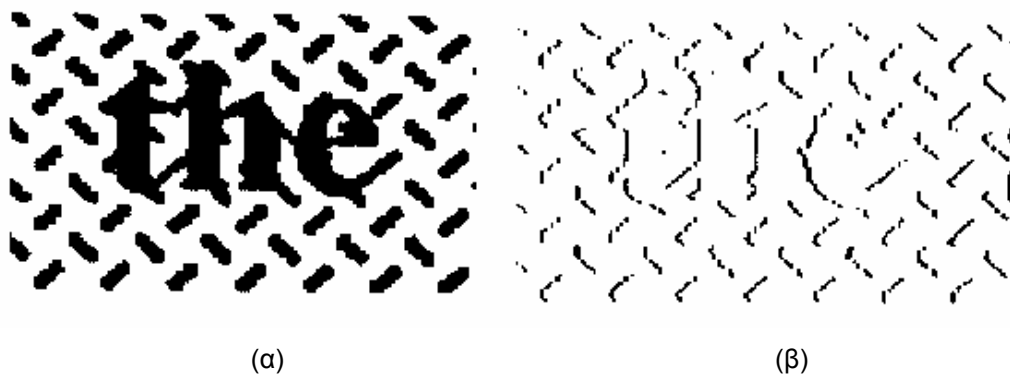
Σχήμα 3.16. Αποτέλεσμα του erosion της εικόνας χρησιμοποιώντας το δομικό στοιχείο T1. (α) Η αρχική εικόνα. (β) Η εικόνα μετά το erosion με το δομικό στοιχείο T1.
