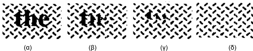
Σχήμα 3.19. Το αποτέλεσμα της διαδικασίας εντοπισμού των διαδοχικών συμβόλων του υποβάθρου σε εικόνα κειμένου. (α)-(δ) Τα αποτελέσματα των διαδοχικών επαναλήψεων.
