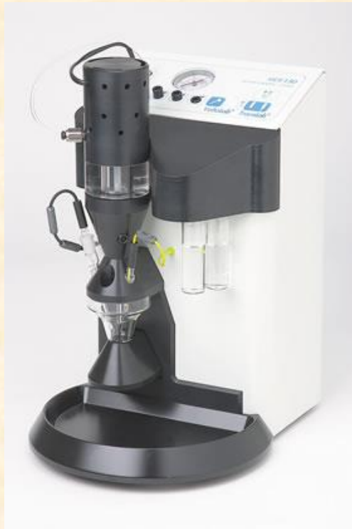
Ελεγχόμενο σταγονικό ηλεκτρόδιο + κυψελίδα
