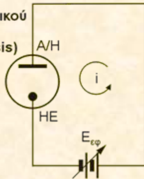
A/H (αντιηλεκτρόδιο) HE (ηλ. εργασίας)
