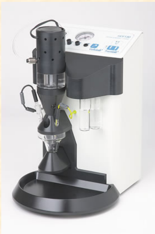
Ελεγχόμενο σταγονικό ηλεκτρόδιο + κυψελίδα
