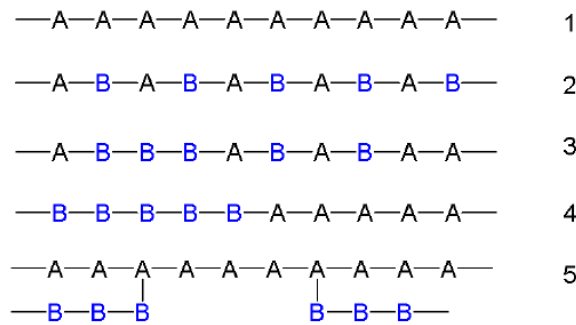
Σχήμα 2.10. Διάφορα είδη συμπολυμερών : 1) Ομοπολυμερές, 2) Εναλλασόμενο, 3) Τυχαίο, 4) Συσταδικό, 5) Διακλαδισμένο
