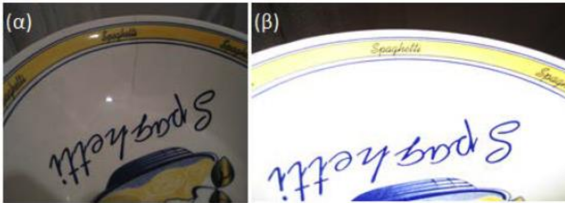
Σχήμα 8.3 Σε κανονικές συνθήκες φωτισμού η ρωγμή είναι εμφανής στο πιάτο (α). Σε συνθήκες έντονου φωτισμού (φλας) η ρωγμή δεν είναι εμφανής (β).
