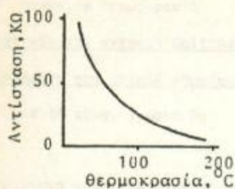
Χαρακτηριστικό διάγραμμα μεταβολής αντίστασεως θερμίστορ
