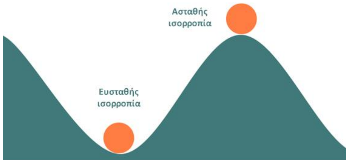
Σχήμα 5.1: Χαρακτηριστική περίπτωση ευσταθούς και ασταθούς ισορροπίας. Στην ευσταθή κατάσταση, το σώμα επιστρέφει γρήγορα σε ισορροπία, μετά από μία μικρή διατάραξη. Στην ασταθή κατάσταση, μία εξωτερική διατάραξη είναι ικανή να εκτρέψει πλήρως το σώμα από την ισορροπία.
