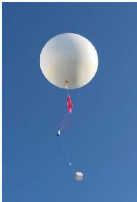
Εικόνα 9.2 Ραδιοβολίδα. Διακρίνεται το μπαλόνι, το αλεξίπτωτο και το πακέτο των οργάνων.
