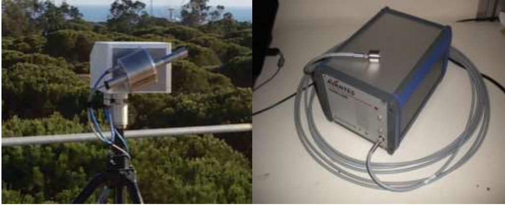
Εικόνα 11.2 Το σύστημα DOAS Φαέθων (Εργαστήριο Φυσικής της Ατμόσφαιρας, ΑΠΘ). Αριστερά είναι διάταξη συλλογής της ηλιακής ακτινοβολίας και δεξιά ο οπτικός αναλυτής.
