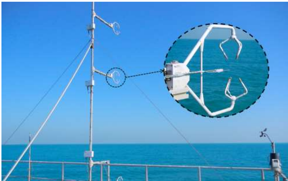
Εικόνα 4.3 Ηχητικό ανεμόμετρο τοποθετημένο σε μετεωρολογικό πύργο (δεξιά) και κοινοτικό πλάνο στο οποίο εμφανίζονται τα τρία ζεύγη για τη μέτρηση των τριών συνιστωσών του ανέμου.
