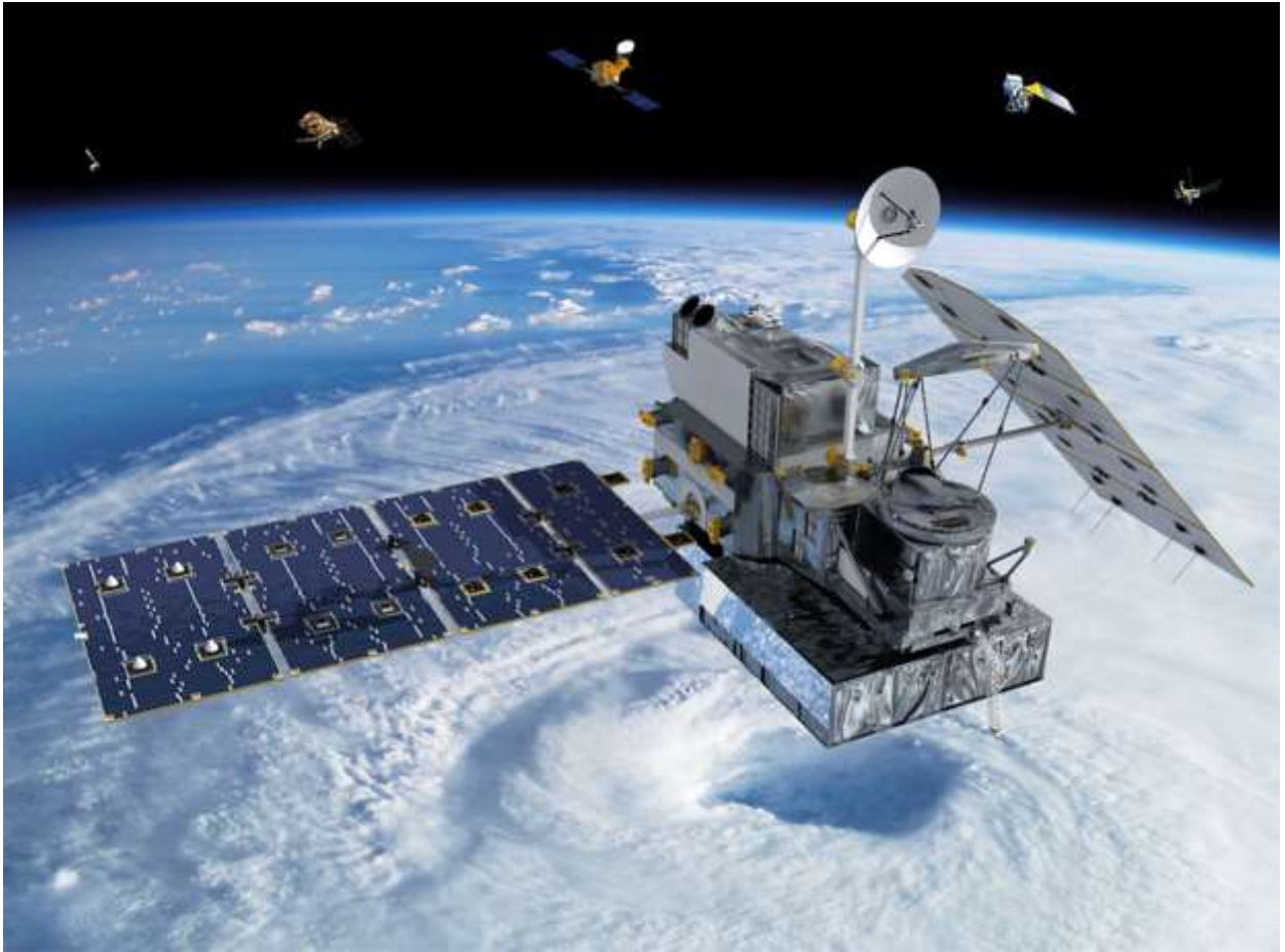
Εικόνα 6.7 Ο δορυφόρος GPM Core Observatory σε τροχιά γύρω από τη Γη. Η Παγκόσμια Μέτρηση Υετού (Global Precipitation Measurement, GPM) είναι μια διεθνής αποστολή δορυφόρου για μετρήσεις υετού από το διάστημα που παρέχει παγκόσμιες παρατηρήσεις για τη βροχή και το χιόνι διεθνώς κάθε τρεις ώρες (πηγή://en.wikipedia.org/wiki/Global_Precipitation_Measurement#/media/File:Visualization_of_the_GPM_Core_Observatory_and_Partner_Satellites.jpg)
