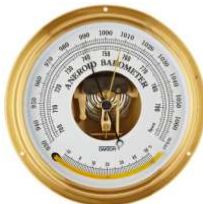
Εικόνα 5.2: Συνηθισμένο μεταλλικό βαρόμετρο του εμπορίου. Η ατμοσφαιρική πίεση εμφανίζεται, τόσο σε ίντσες υδραργύρου (εξωτερική κλίμακα) όσο και σε mbar (εσωτερική κλίμακα).
