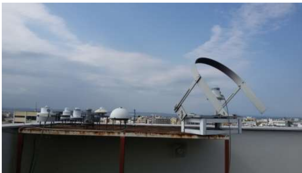
Εικόνα 7.1 Ακτινόμετρα ευρείας φασματικής απόκρισης για τη μέτρηση της πυκνότητας ροής της ηλιακής ακτινοβολίας σε διάφορες φασματικές περιοχές. Δεξιά διακρίνεται ένα σκιάδιο για τη μέτρηση της διάχυτης συνιστώσας της ηλιακής ακτινοβολίας. (Εργαστήριο Φυσικής της Ατμόσφαιρας, τμήμα Φυσικής, ΑΠΘ)
