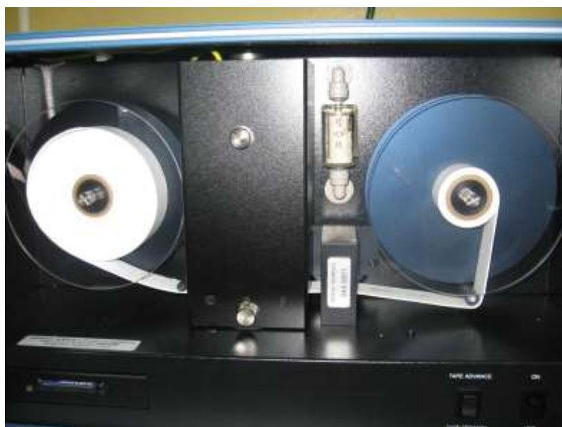
Εικόνα 8.4 Διάταξη αιθαλόμετρου για τη μέτρηση του μαύρου άνθρακα.
