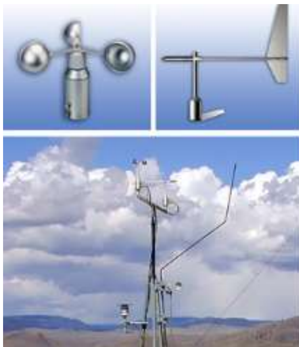
Εικόνα 4.1 Ανεμόμετρο τριών κυπέλλων (επάνω αριστερά) και ανεμοδείκτης (επάνω δεξιά), τοποθετημένα σε χαμηλό ιστό (κάτω).
