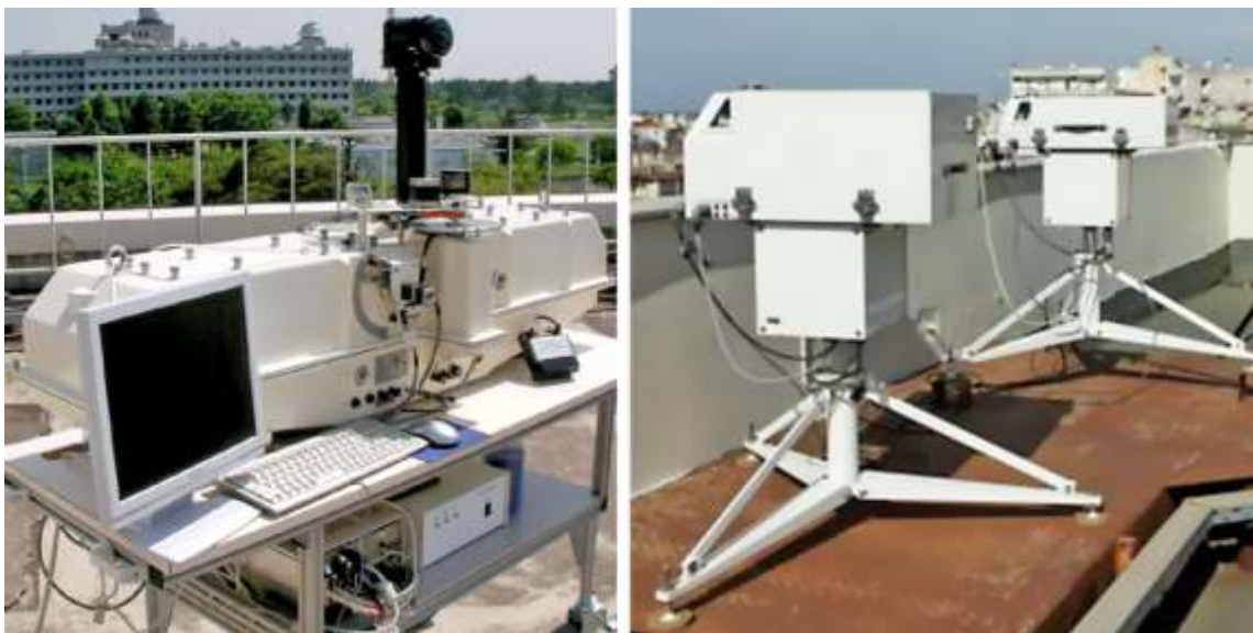
Εικόνα 11.1 Φασματοφωτόμετρα τύπου Dobson ( Aerological Observatory Tsukuba, Ιαπωνική Μετεωρολογική Υπηρεσία ) και Brewer ( Εργαστήριο Φυσικής της Ατμόσφαιρας, ΑΠΘ ).
