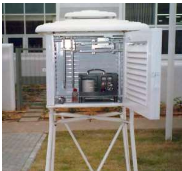
Εικόνα 2.3 Μετεωρολογικός κλωβός. Φαίνονται ο θερμογράφος/υγρογράφος, όπως και τα διάφορα θερμόμετρα.
