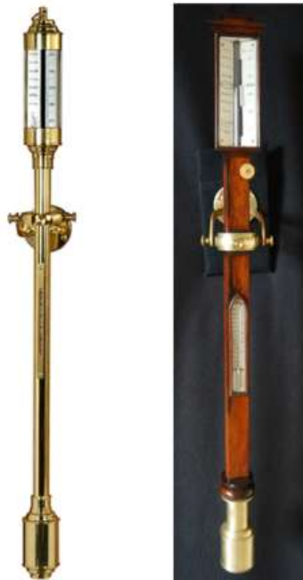
Εικόνα 5.1 Τύποι υδραργυρικών βαρομέτρων. Το δοχείο υδραργύρου βρίσκεται στο κάτω μέρος, ενώ η κλίμακα στο πάνω μέρος του βαρομέτρου.
