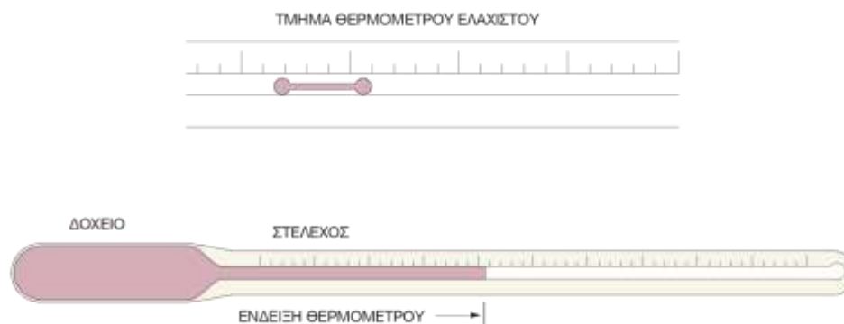
Σχήμα 2.1α Τμήματα ενός θερμόμετρου υγρού. Στο επάνω σχήμα εμφανίζεται λεπτομέρεια από θερμόμετρο ελαχίστου στην οποία φαίνεται ο δείκτης ελάχιστης θερμοκρασίας.
