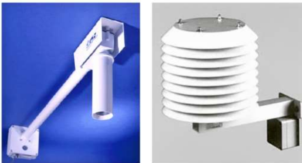
Εικόνα 2.4 Εξαεριζόμενο κάλυμμα θερμομέτρου (αριστερά). Κάλυμμα για θερμόμετρο/υγρόμετρο με περύγια τα οποία επιτρέπουν τον φυσικό αερισμό του εσωτερικού ακόμης και σε χαμηλές ταχύτητες ανέμου (δεξιά).
