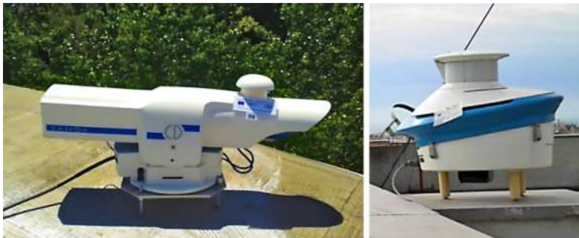
Εικόνα 11.3 Σύστημα οριζόντιας διαδρομής DOAS του οίκου Environment SA (ΑΠΘ). Αριστερά είναι η πηγή λευκού φωτός (λυχνία Ξένου) και δεξιά η μονάδα που περιέχει το συλλέκτη και τον οπτικό αναλυτή.
