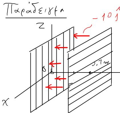
Έχω δύο πλακάκια σχήματος πλάκας με μεταξύ τους απόσταση  $0.1\text{m}$ . Το δυναμικό αναφέρεται στους είναι  $V = 10 \cdot y$
