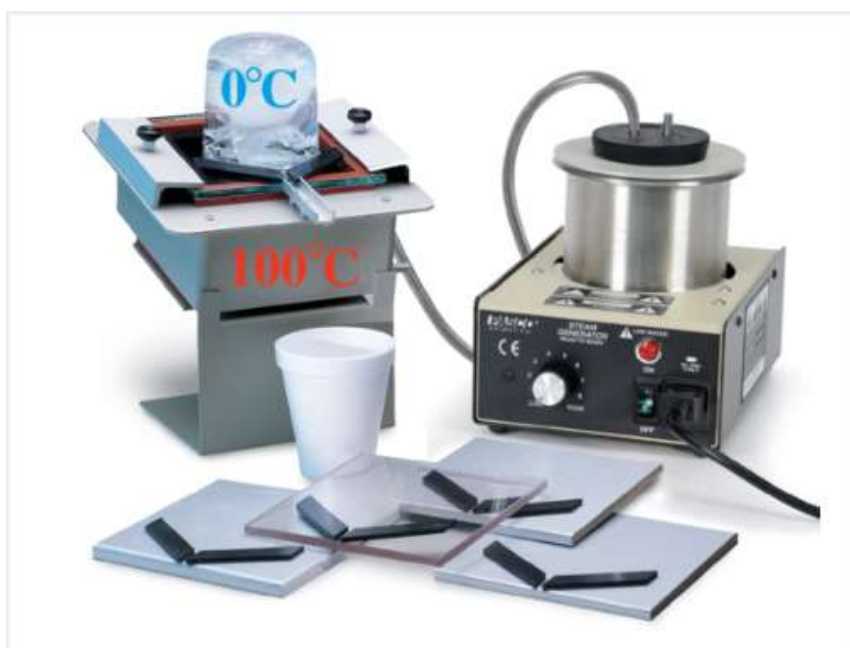
Σχήμα 1. Η Διάταξη Θερμικής Αγωγιμότητας μαζί με 5 δείγματα.
