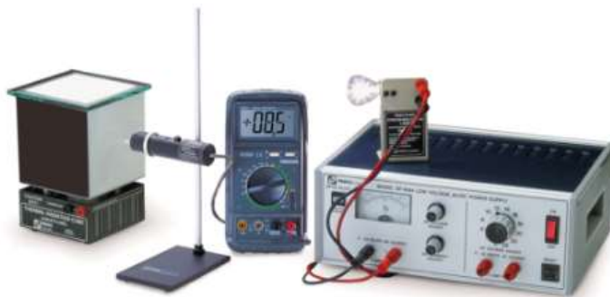
Σχήμα 1. Διάταξη αδιαβατικών μεταβολών αερίου.
