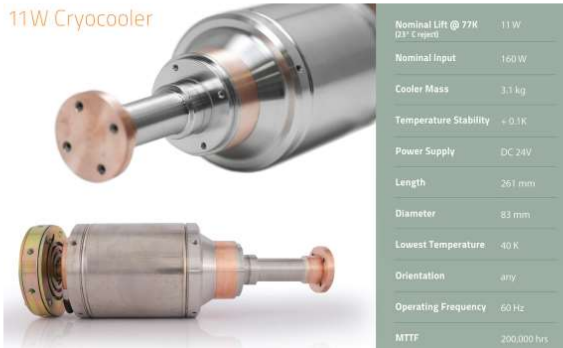
Σχήμα 6. Τεχνικά χαρακτηριστικά του κρυογονικού ψύκτη CryoTel® CT της εταιρείας Sunpower. http://sunpowerinc.com/cryocoolers/cryotel-family/ct/
