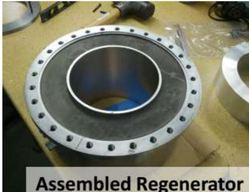
Σχήμα 3. Πάνω: Εικόνα του πλέγματος του αναγεννητή.
