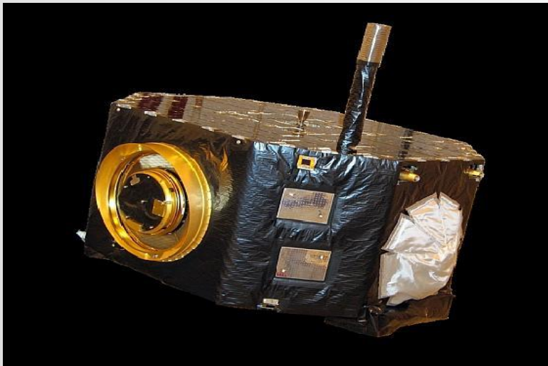
IBEX-Lo, Αισθητήρας σωματιδίων < 2 keV
