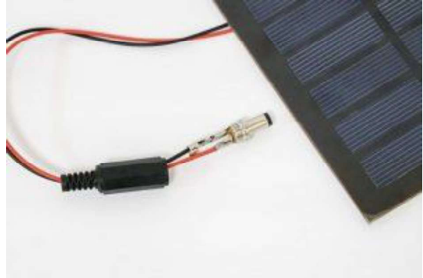
Εικόνα 13: Σύνδεση φωτοβολατικού με led (Πηγή: Device Plus Editorial Team, 2020)
