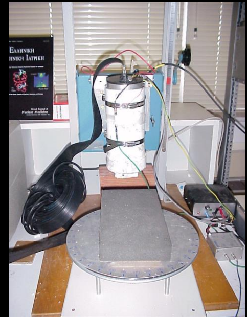
IASA CsI(Tl) gamma camera Lazaro et al, Phys Med Biol 2004
