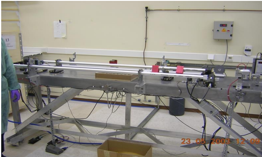
Κατασκευή θαλάμων μονίων στο Πανεπιστήμιο Αθηνών
