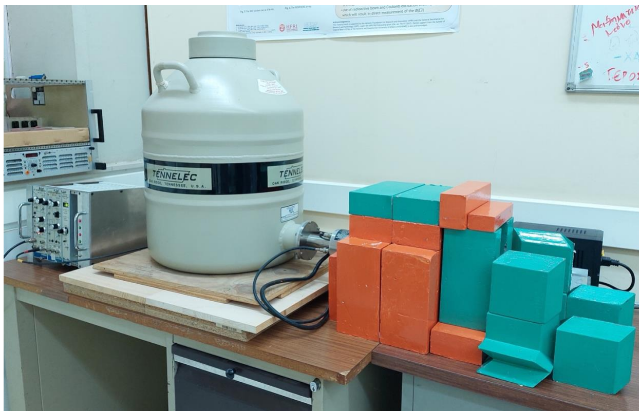
Εικόνα 8 - Ο ανιχνευτής HPGe. Ο κρύσταλλος περιβάλλεται από μολυβδότουβλα συνολικού πάχους 10cm για μείωση του υποβάθρου λόγω κοσμικής ακτινοβολίας. Είναι εμφανές το δοχείο υγρού αζώτου (LN2) το οποίο διατηρεί τον κρύσταλλο σε χαμηλές θερμοκρασίες. Αριστερά διακρίνεται η κονσόλα NIM με τις μονάδες υποστήριξης (τροφοδοτικό υψηλής τάσης και ενισχυτής σήματος).
