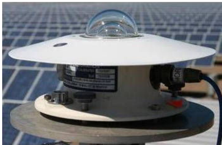
Σχήμα 4. Η Σχήμα ενός πυρανομέτρου. Είναι εμφανής ο διπλός θόλος από γυαλί που προστατεύει τους αισθητήρες, καθώς και το αδιάβροχο καλώδιο από την πλευρά που μεταφέρονται τα ηλεκτρικά σήματα που αντιστοιχούν στην προσπίπτουσα ηλιακή ακτινοβολία. ( Steve Wilcox courtesy of US Department of Energy/National Renewable Energy Laboratory (US DOE/NREL).
