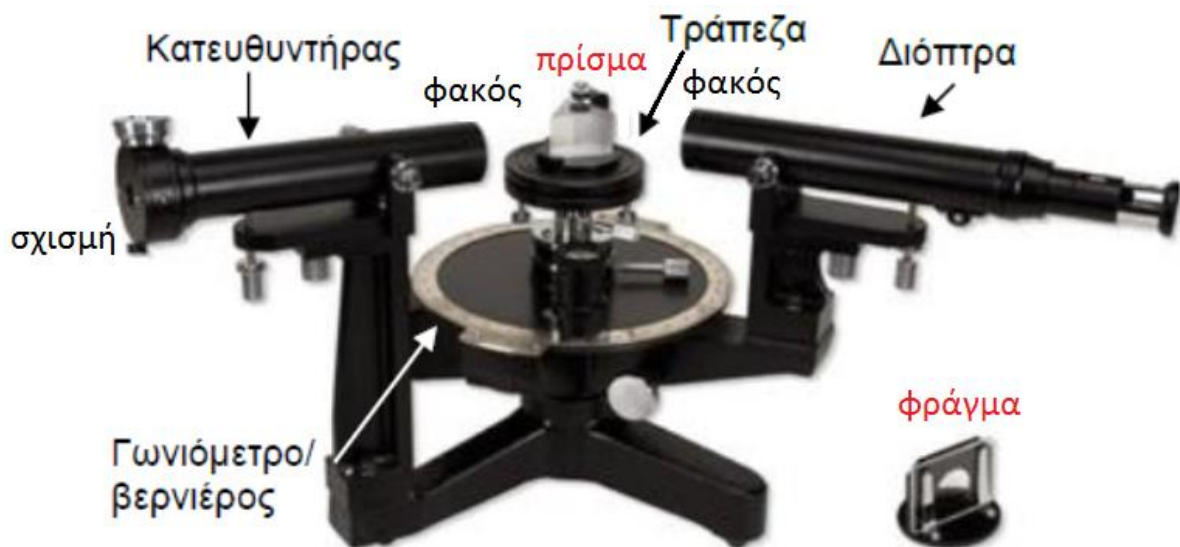
Σχήμα 1. Εικόνα φασματοσκοπίου πρίσματος ή φράγματος και ταυτοποίηση των κύριων εξαρτημάτων του. Στη συγκεκριμένη εικόνα την ανάλυση των ΗΜ κυμάτων προκαλεί ένα πρίσμα, οπότε αυτό είναι φασματοσκόπιο πρίσματος. Αν το πρίσμα αντικατασταθεί με φράγμα έχουμε φασματοσκόπιο φράγματος.
