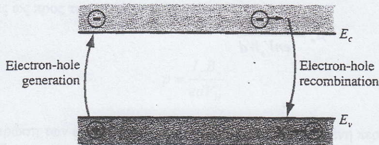
Σχήμα 4.1 Δημιουργία και επανασύνδεση ηλεκτρονίων-οπών
