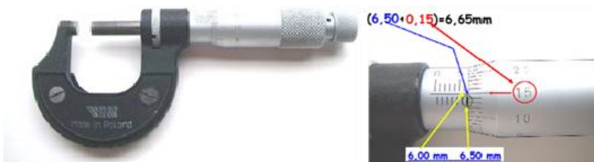
Σχήμα 4: Ένα μικρόμετρο και λεπτομέρεια των κλιμάκων του
