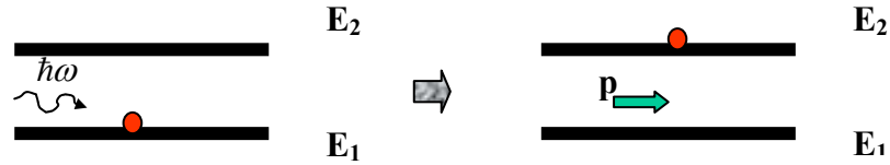
Σχήμα 2-3 Μηχανισμός απορρόφησης φωτονίου από αρχικά ακίνητο άτομο
