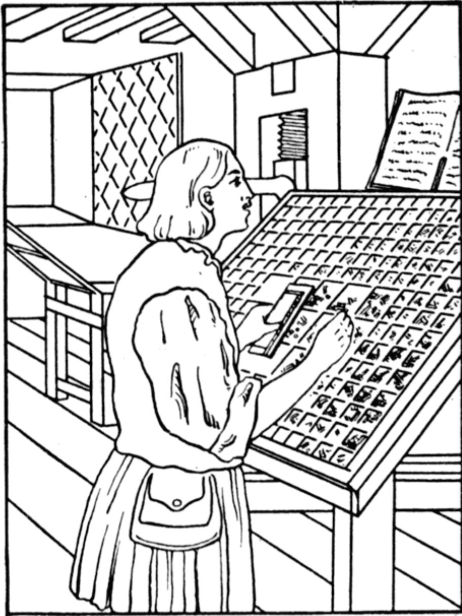
Εικόνα 3.1: Τοποθέτηση μεταλλικών στοιχείων σε κάσα.
