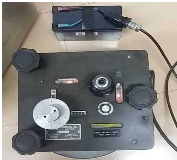
Αρχή λειτουργίας βαρυτομέτρου LaCoste & Romberg
