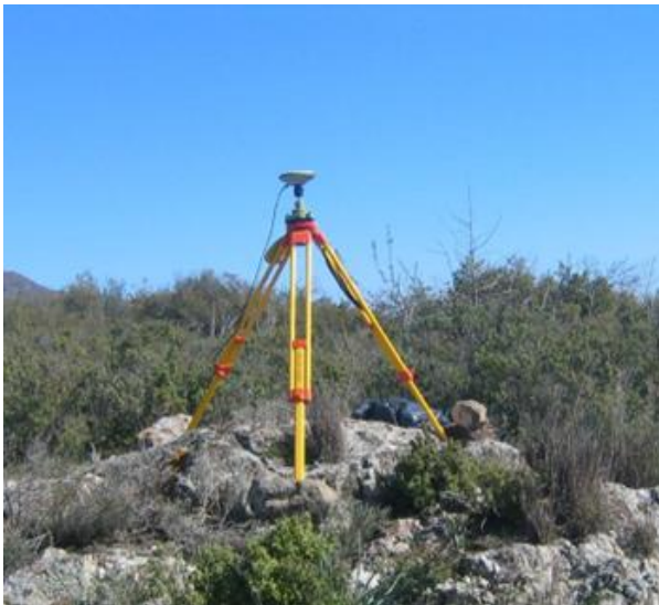
Δορυφορικές γεωδαιτικές μετρήσεις GPS/GNSS σε μη-μόνιμο σταθμό και σε μόνιμο σημείο.
