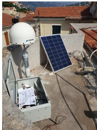
Δορυφορικές γεωδαιτικές μετρήσεις GPS/GNSS σε μη-μόνιμο σταθμό και σε μόνιμο σημείο.
