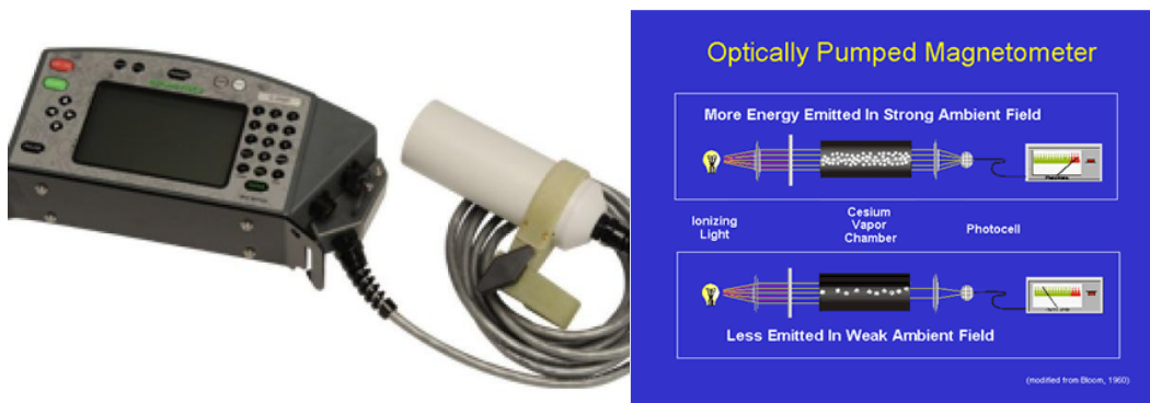
Μαγνητόμετρο Οπτικής Άντλησης (Geometrics G858)
