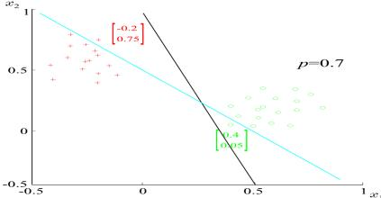
$$\underline{w}(t+1) = \begin{bmatrix} 1\\1\\-0.5 \end{bmatrix} - 0.7(-1) \begin{bmatrix} 0.4\\0.05\\1 \end{bmatrix} - 0.7(+1) \begin{bmatrix} -0.2\\0.75\\1 \end{bmatrix} = \begin{bmatrix} 1.42\\0.51\\-0.5 \end{bmatrix}$$
