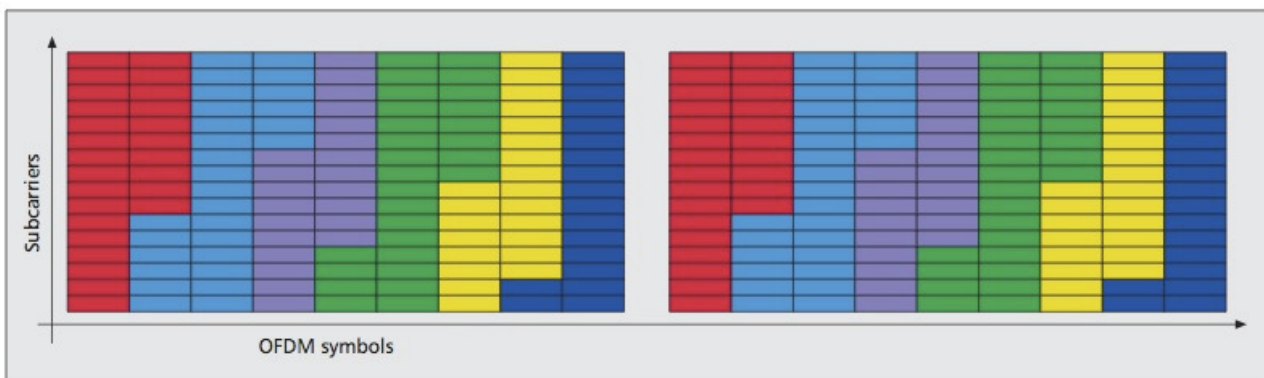
Εικόνα 3: Διαφορετικά PLPs που κατέχουν διαφορετικές τομές διαμόρφωσης, ρυθμού κωδικοποίησης και time interleaving. Παρουσιάζονται δύο πλαίσια.
