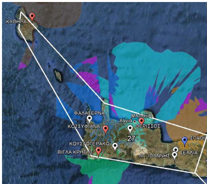
Σχήμα 341. Συγχρονισμός του Allotment 27 (Best Server, RPC2) με ενεργά μόνο τα απαραίτητα κέντρα εκπομπής.
