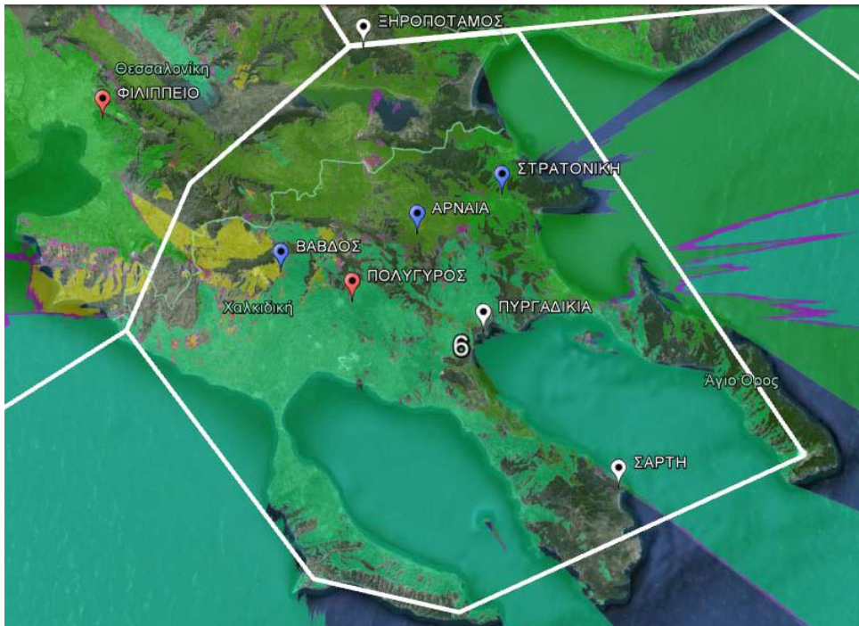
Σχήμα 81. Συγχρονισμός του Allotment 6 (Best Server, RPC1) με ενεργά μόνο τα απαραίτητα κέντρα εκπομπής.
