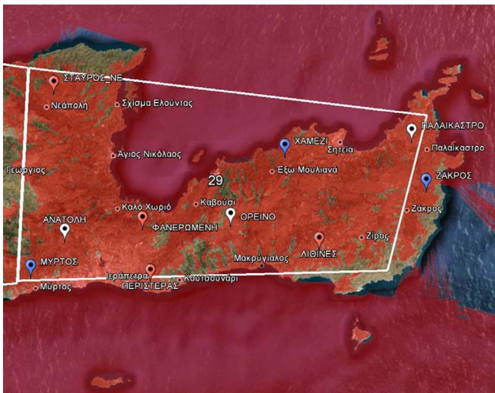
Σχήμα 356. Κάλυψη του Allotment 29 σε κατώφλι 49 dBu με ενεργά όλα τα κέντρα εκπομπής.
