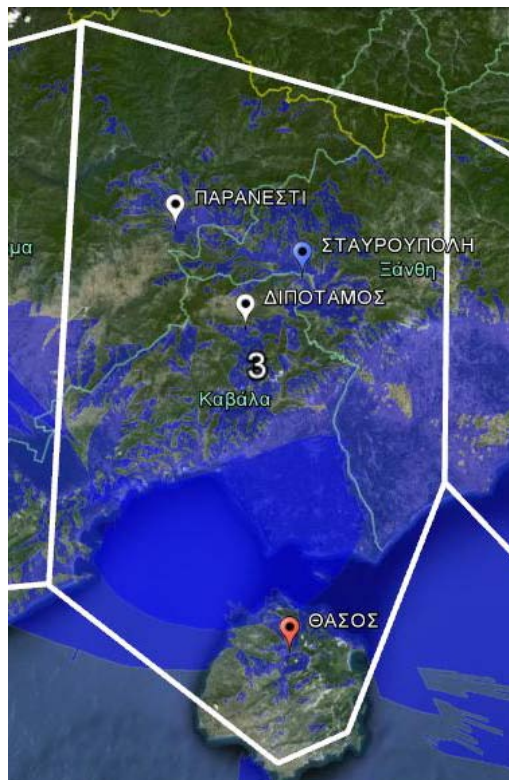
Σχήμα 39. Κάλυψη του Allotment 3 σε κατώφλι 74 dBu με ενεργά όλα τα κέντρα εκπομπής.
