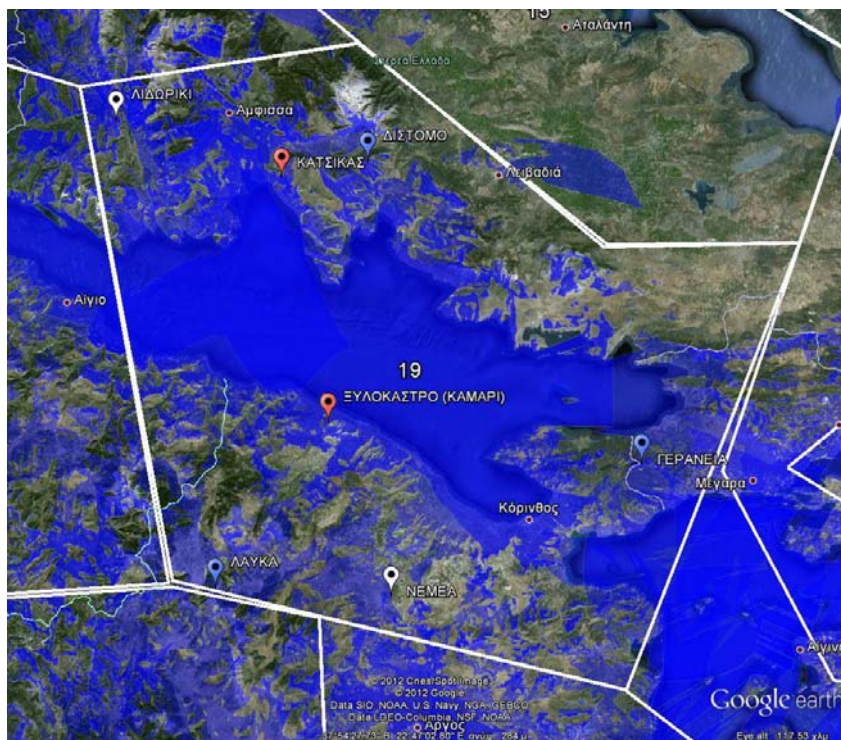
Σχήμα 235. Κάλυψη του Allotment 19 σε κατώφλι 74 dBu με ενεργά όλα τα κέντρα εκπομπής.
