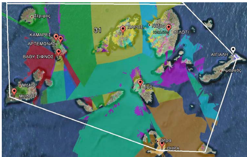
Σχήμα 392. Συγχρονισμός του SFN-2 του A31 (First Server, RPC2) με ενεργά όλα τα κέντρα εκπομπής.
