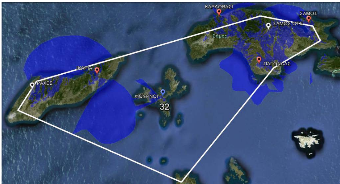
Σχήμα 401. Κάλυψη του Allotment 32 σε κατώφλι 74 dBu με ενεργά όλα τα κέντρα εκπομπής.
