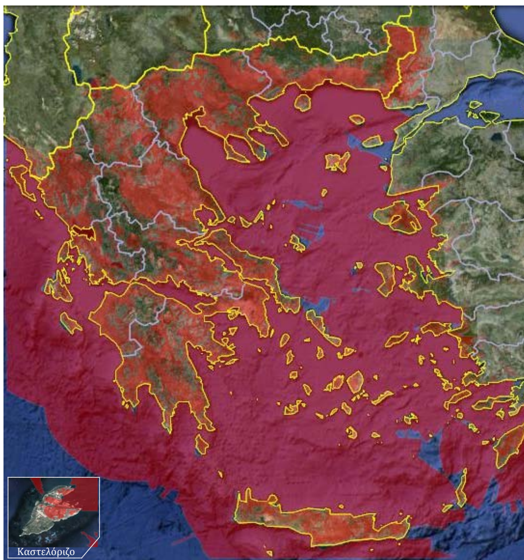
Σχήμα 9. Ραδιοκάλυψη Επικράτειας μόνο με τα Απαραίτητα ΚΕ για λήψη με διάταξη RPC1.
