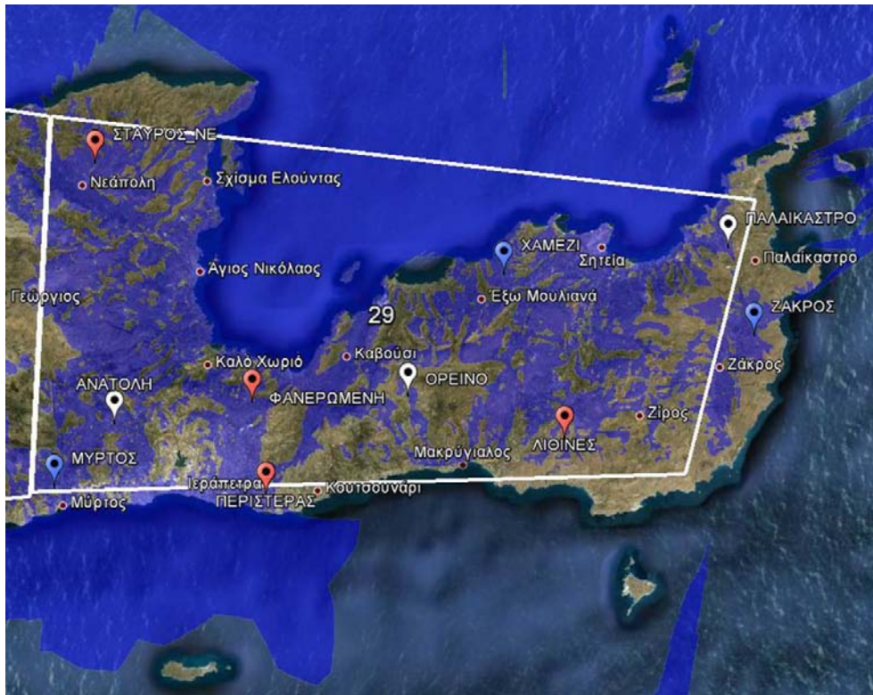
Σχήμα 353. Κάλυψη του Allotment 29 σε κατώφλι 74 dBu με ενεργά μόνο τα απαραίτητα κέντρα εκπομπής.
