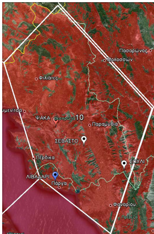
Σχήμα 126. Κάλυψη του Allotment 10 σε κατώφλι 49 dBu με ενεργά όλα τα κέντρα εκπομπής.
