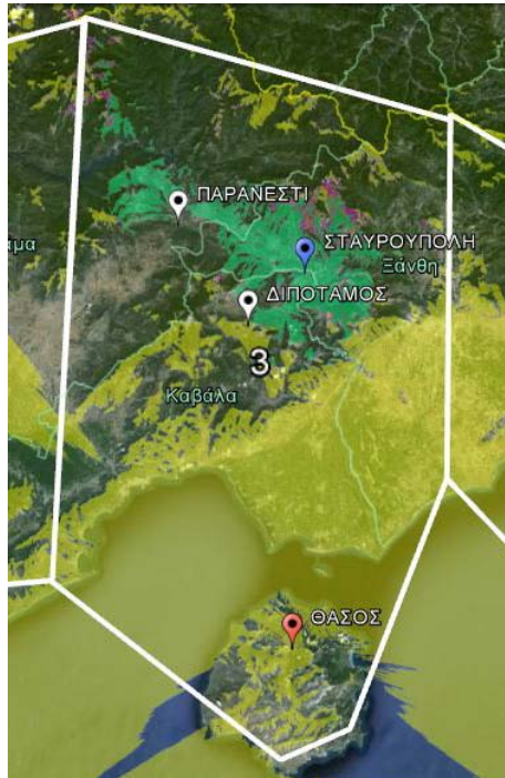
Σχήμα 48. Συγχρονισμός του Allotment 3 (Best Server, RPC1) με ενεργά μόνο τα απαραίτητα κέντρα εκπομπής.
