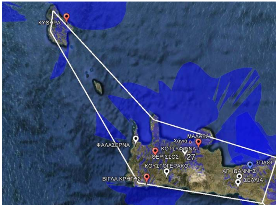
Σχήμα 333. Κάλυψη του Allotment 27 σε κατώφλι 74 dBu με ενεργά μόνο τα απαραίτητα κέντρα εκπομπής.
