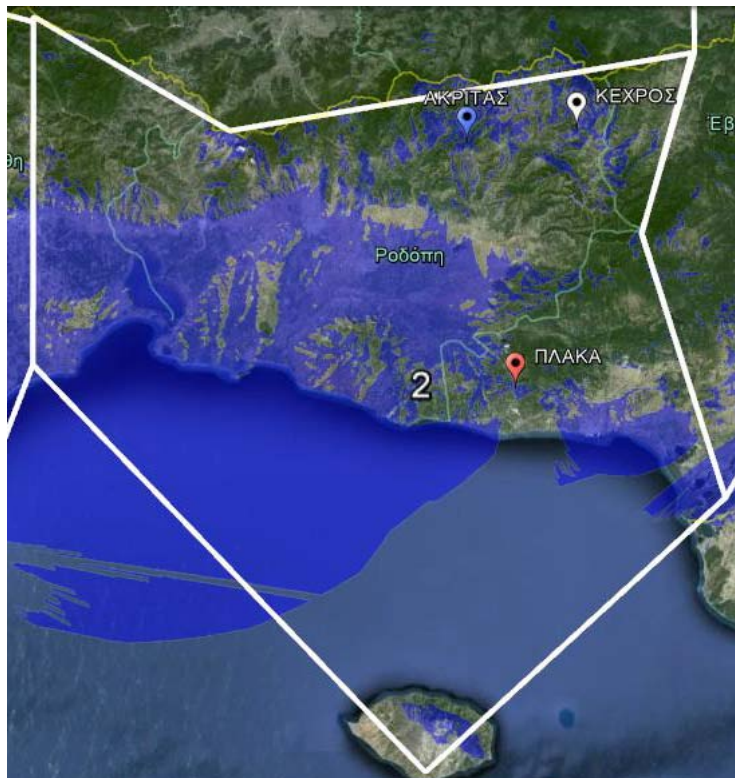
Σχήμα 26. Κάλυψη του Allotment 2 σε κατώφλι 74 dBu με ενεργά όλα τα κέντρα εκπομπής.
