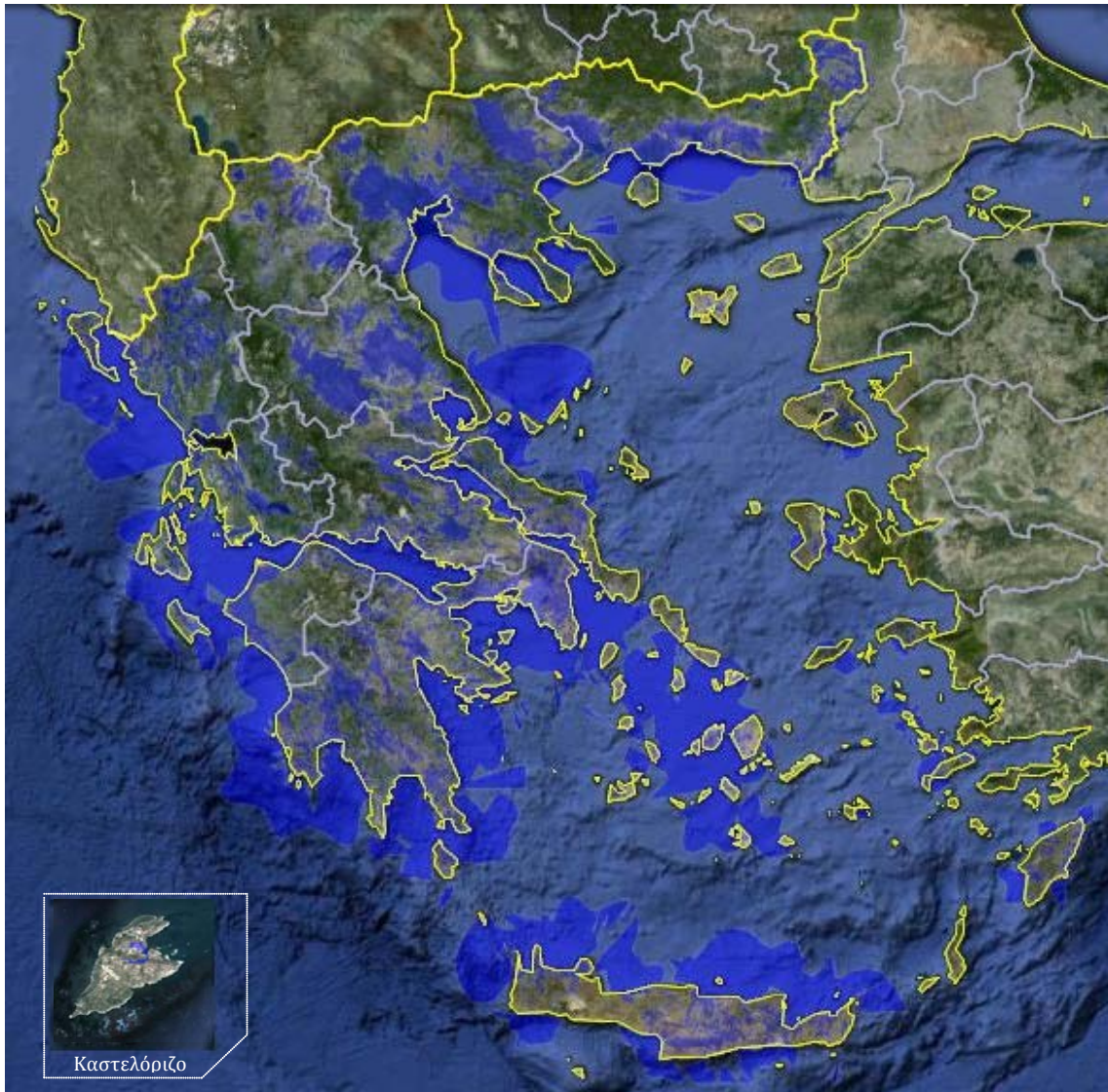
Σχήμα 7. Ραδιοκάλυψη Επικράτειας μόνο με τα Απαραίτητα ΚΕ για λήψη με διάταξη RPC2.
