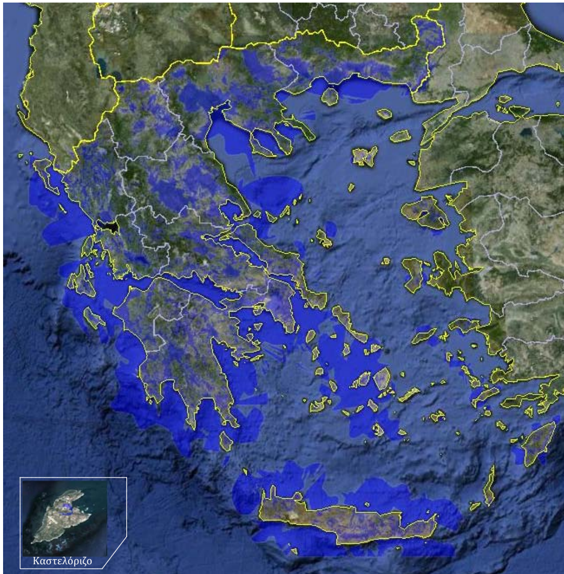
Σχήμα 8. Ραδιοκάλυψη Επικράτειας με όλα τα ΚΕ (Απαραίτητα και Επικουρικά) για λήψη με διάταξη RPC2.
