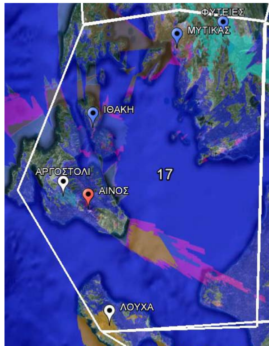
Σχήμα 219. Συγχρονισμός του Allotment 17 (Best Server, RPC1) με ενεργά όλα τα κέντρα εκπομπής.
