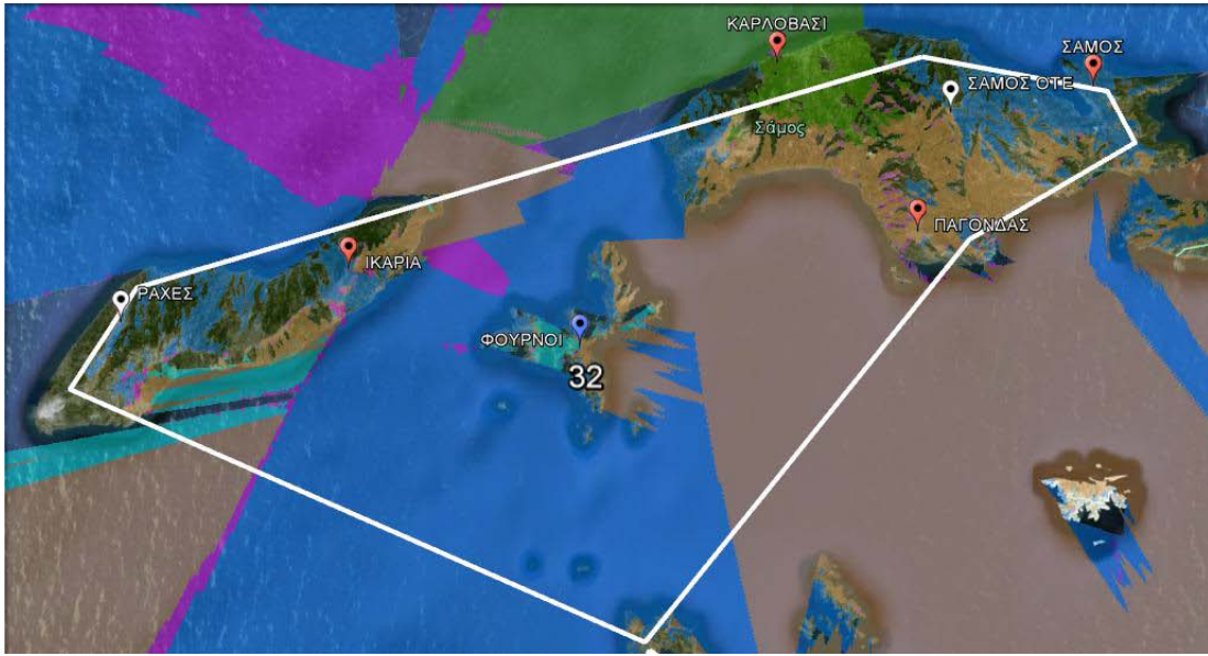
Σχήμα 406. Συγχρονισμός του Allotment 32 (First Server, RPC1) με ενεργά μόνο τα απαραίτητα κέντρα εκπομπής.
