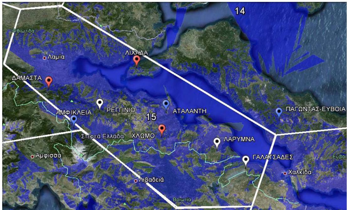
Σχήμα 183. Κάλυψη του Allotment 15 σε κατώφλι 74 dBu με ενεργά όλα τα κέντρα εκπομπής.
