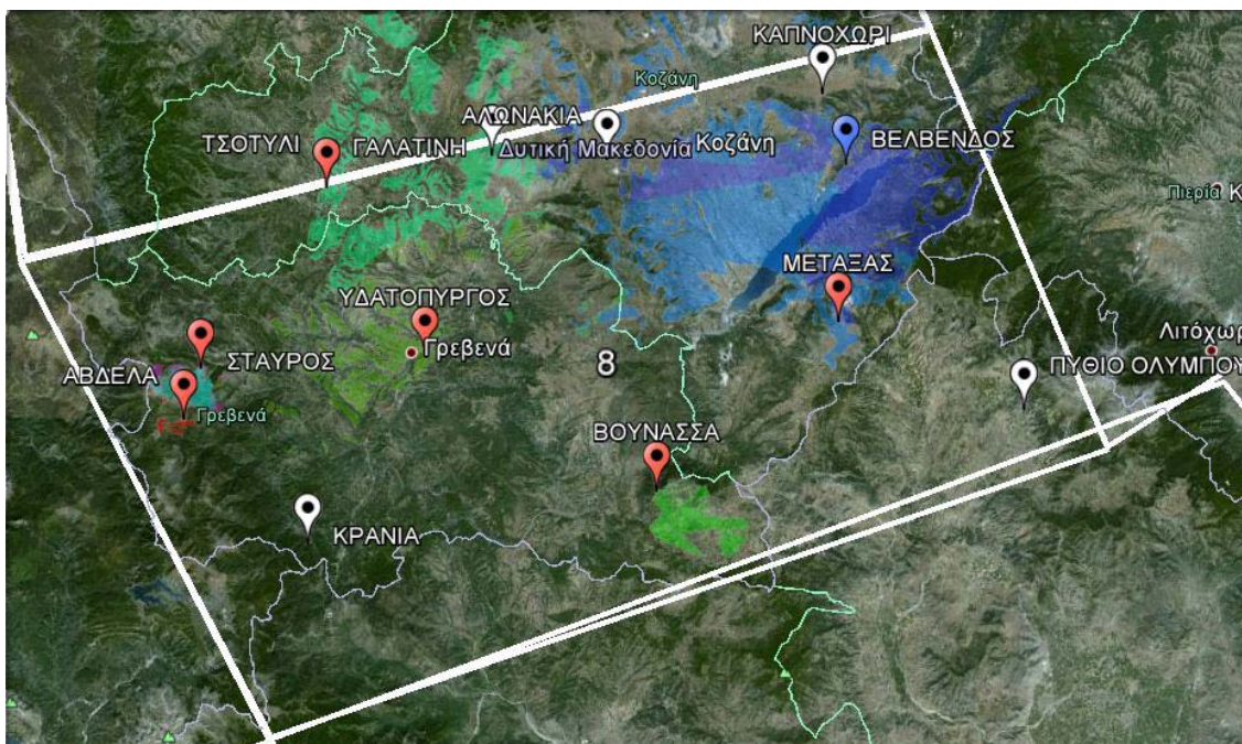
Σχήμα 101. Συγχρονισμός του Allotment 8 (First Server, RPC2) με ενεργά μόνο τα απαραίτητα κέντρα εκπομπής.
