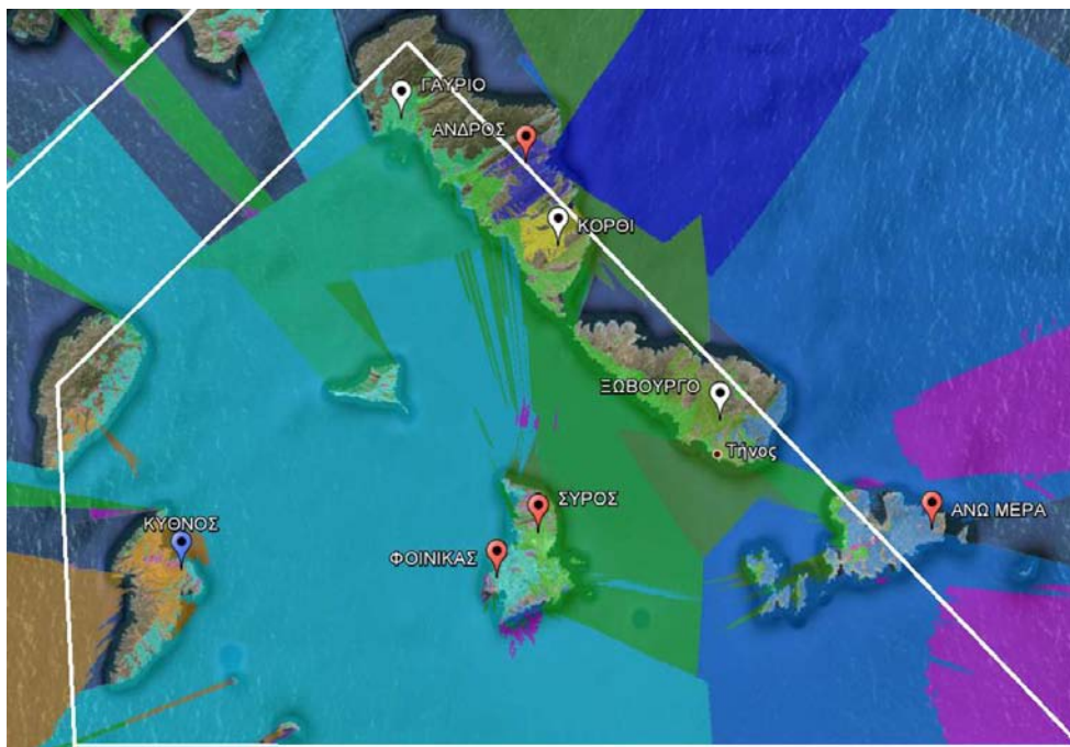
Σχήμα 386. Συγχρονισμός του SFN-1 του A31 (First Server, RPC1) με ενεργά όλα τα κέντρα εκπομπής.
