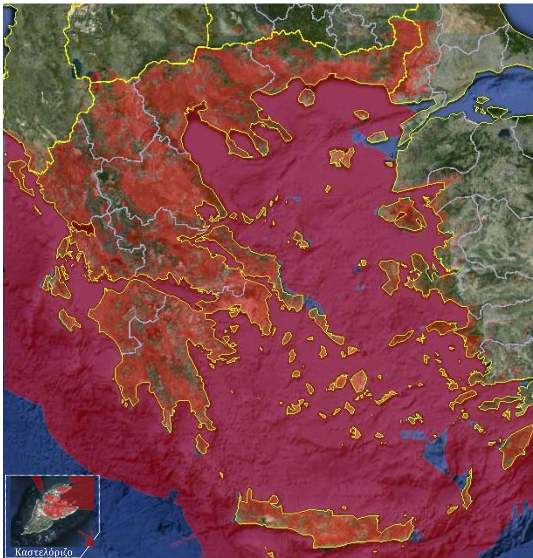
Σχήμα 10. Ραδιοκάλυψη Επικράτειας με όλα τα ΚΕ (Απαραίτητα και Επικουρικά) για λήψη με διάταξη RPC1.
