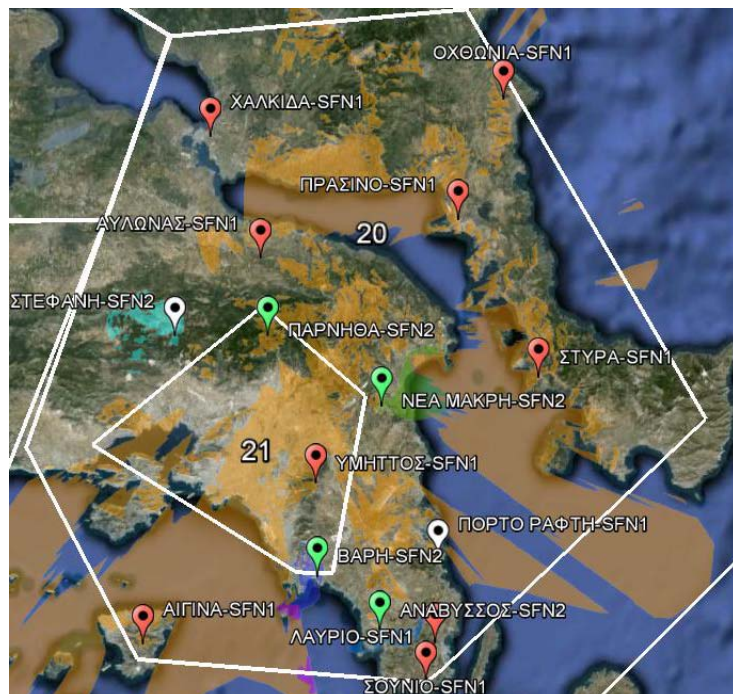
Σχήμα 264. Συγχρονισμός του Allotment 21 - SFN2 (Best Server, RPC2) με ενεργά όλα τα κέντρα εκπομπής.
