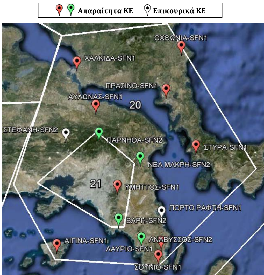
Σχήμα 246. Χωρική διάταξη των κέντρων εκπομπής των Allotments 20 και 21.
