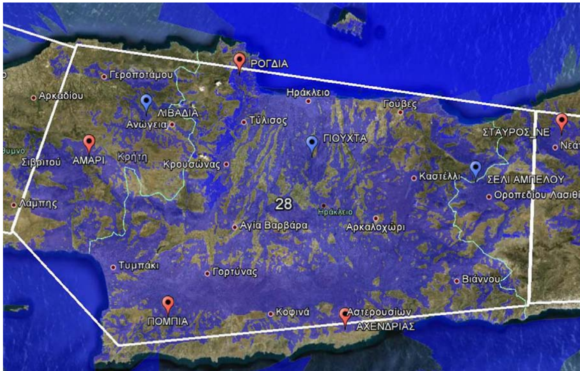
Σχήμα 346. Κάλυψη του Allotment 28 σε κατώφλι 74 dBu με ενεργά τα απαραίτητα κέντρα εκπομπής.
