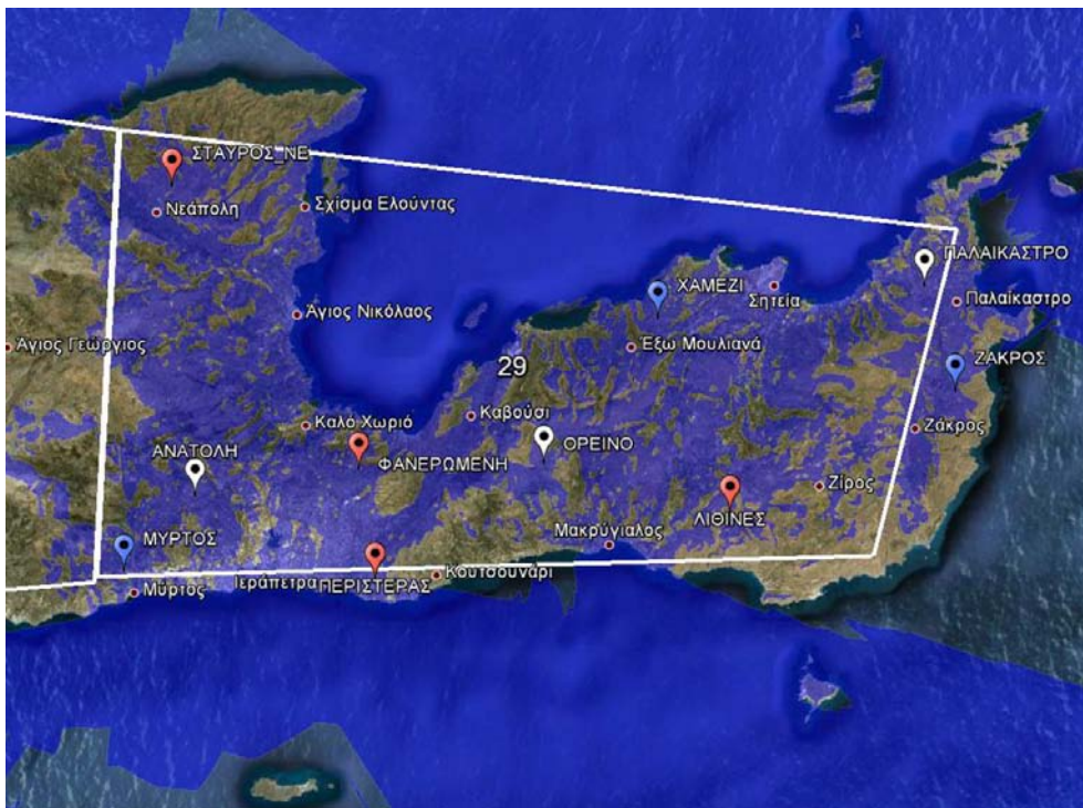
Σχήμα 354. Κάλυψη του Allotment 29 σε κατώφλι 74 dBu με ενεργά όλα τα κέντρα εκπομπής.
