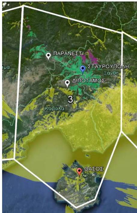
Σχήμα 46. Συγχρονισμός του Allotment 3 (Best Server, RPC2) με ενεργά μόνο τα απαραίτητα κέντρα εκπομπής.
