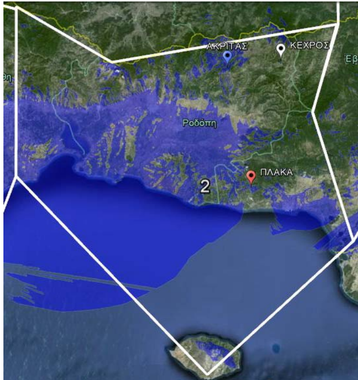
Σχήμα 25. Κάλυψη του Allotment 2 σε κατώφλι 74 dBu με ενεργά μόνο τα απαραίτητα κέντρα εκπομπής.
