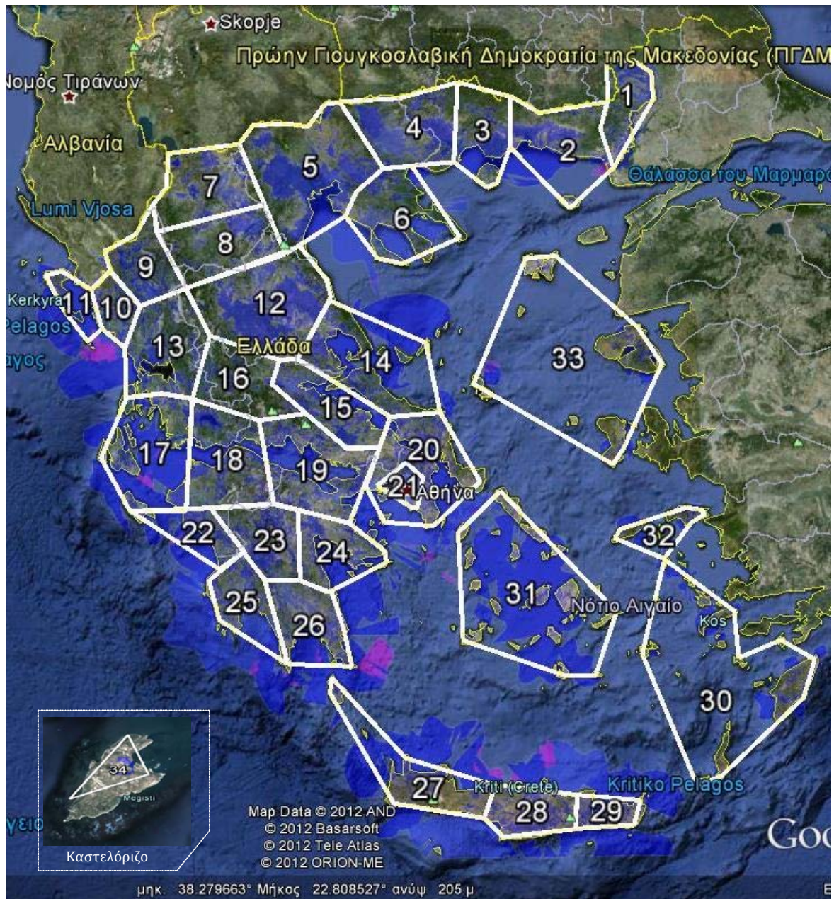
Σχήμα 428. Διάταξη Λήψης RPC2 (κατώφλι 74dBu) με όλα τα ΚΕ ενεργοποιημένα.
