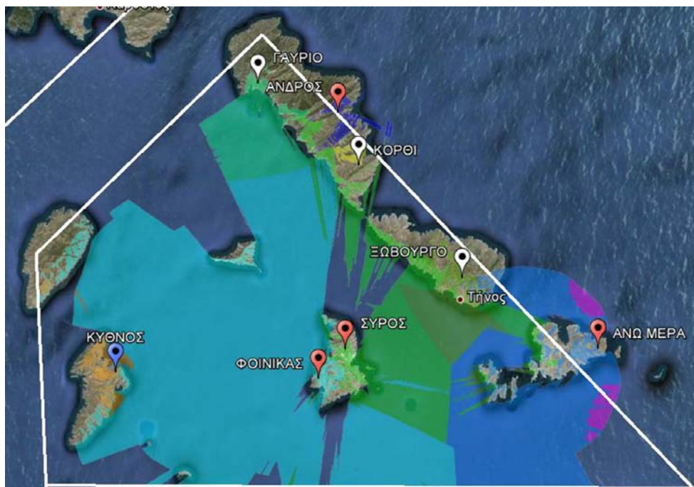
Σχήμα 384. Συγχρονισμός του SFN-1 του Α31 (First Server, RPC2) με ενεργά όλα τα κέντρα εκπομπής.
