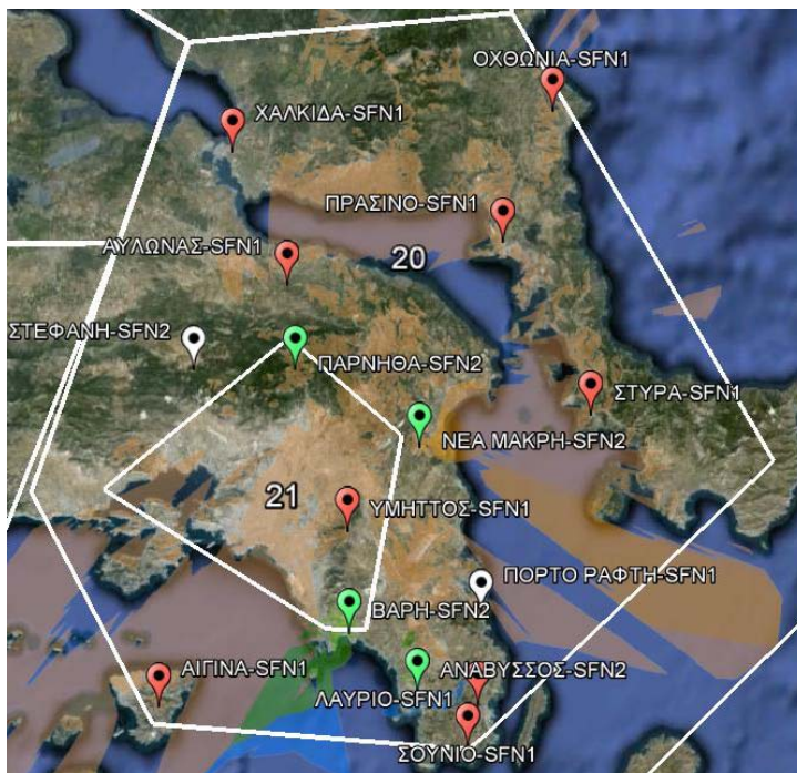
Σχήμα 259. Συγχρονισμός του Allotment 21-SFN2 (First Server, RPC2) με ενεργά μόνο τα απαραίτητα κέντρα εκπομπής
