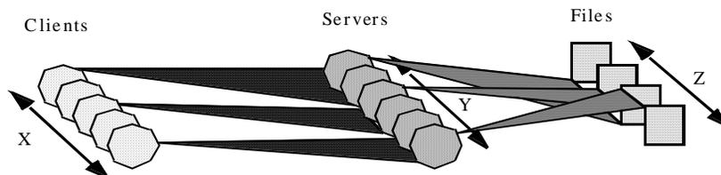
Figure 10. Server-Process-per-Client ( $X*Y*Z$  connections)
