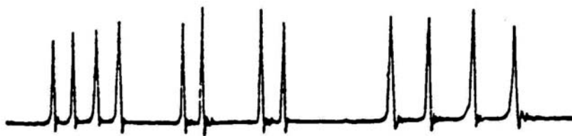
Σχήμα 4.5.9. Απορροφήσεις των βινυλικών πρωτονίων AMX ( \text{CH}_2\text{CHOCOMe} ) συστήματος. Το κάθε βινυλικό πρωτόνιο θα δώσει με τη μέθοδο διακλάδωσης δύο διπλές κορυφές, αφού συζευγνύονται με δύο διαφορετικά πρωτόνια.
