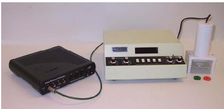
Σχήμα 4-7: Εργαστηριακό σύστημα απαριθμήσεως με ανιχνευτή Geiger – Müller.
