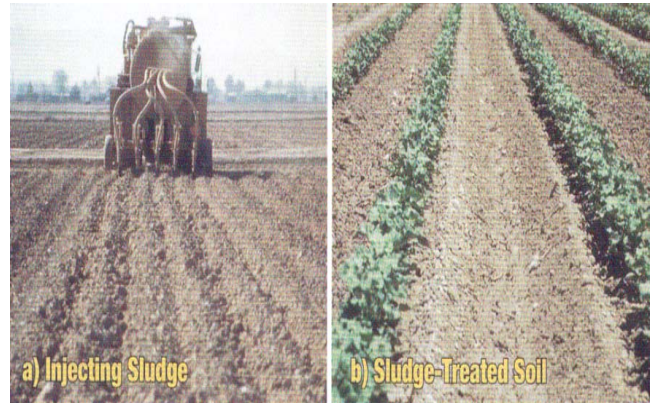
Εικόνα 9. Ελεγχόμενη απόθεση επεξεργασμένης λάσπης από εγκαταστάσεις βιολογικής επεξεργασίας αποβλήτων. Α) Έγχυση της λάσπης στο έδαφος, Β) Ανάπτυξη καλλιέργειας βαμβακιού στην ίδια περιοχή.
