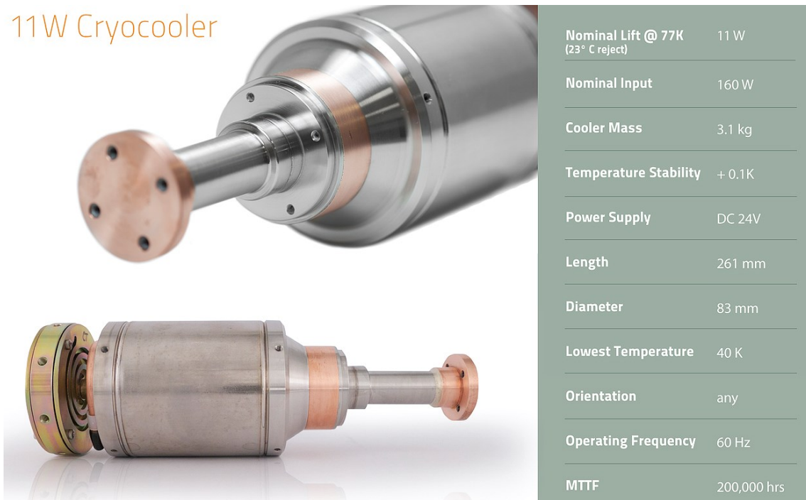
Σχήμα 6. Τεχνικά χαρακτηριστικά του κρυογονικού ψύκτη CryoTel® CT της εταιρείας Sunpower.
