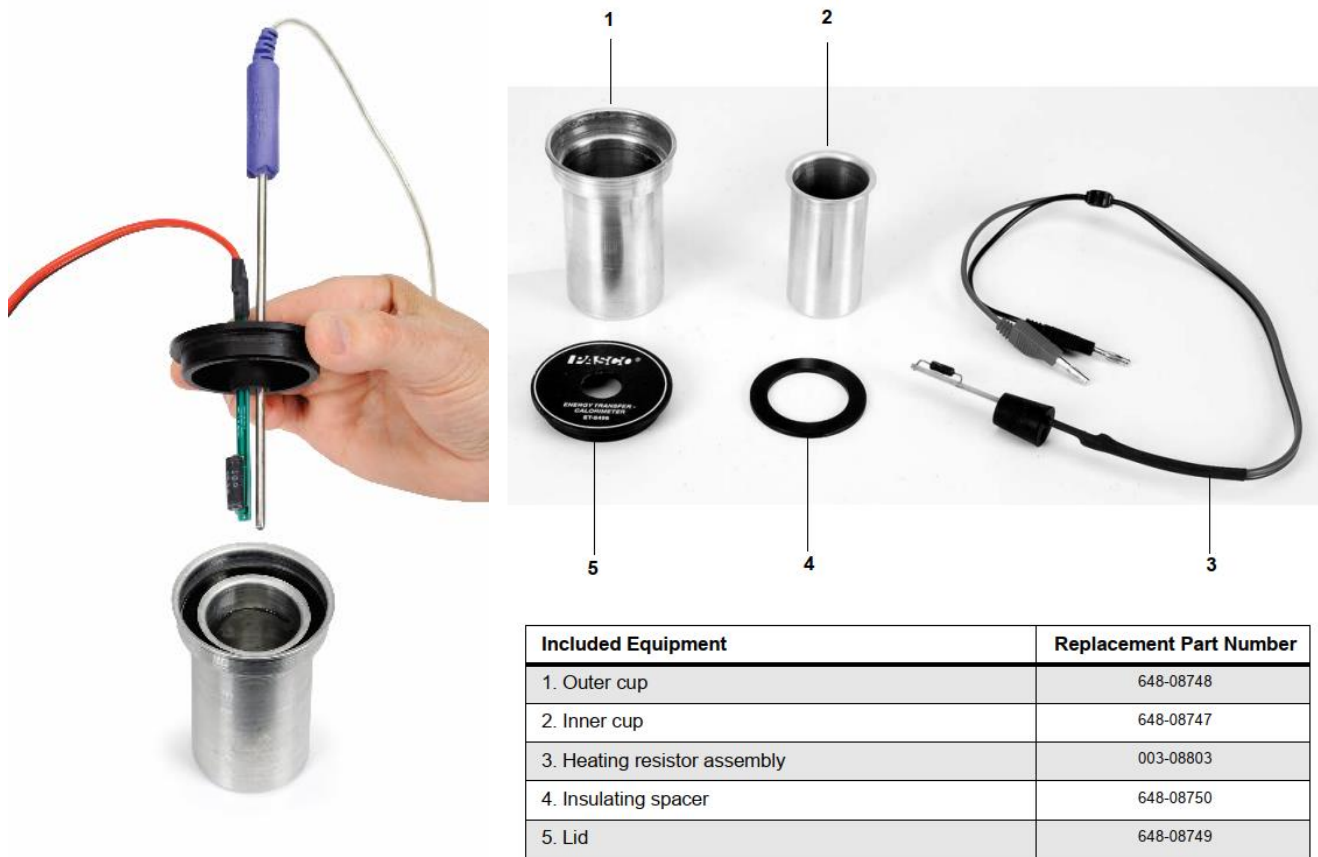
Σχήμα 1. Το θερμιδόμετρο και τα εξαρτήματά του.
