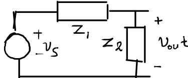
$$V_{out} = V_{in} \cdot \frac{Z_2}{Z_1 + Z_2} \quad (\text{διαπέραντης τάξης}) \quad Z_1 = R, \quad Z_2 = \frac{1}{j\omega C}$$
