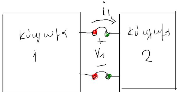
Ισοδύναμο του κυκλώματος 1 ως προς την επίδρασή του στο κυκλώμα 2 είναι ένα άλλο κυκλώμα, το οποίο αν συνδεθεί στους άκρους εισόδου του κυκλώματος 2, θα δώσει ίδια τάση  $V$  και ίδιο ρεύμα  $I$  με αυτό που θα υπήρχε λόγω του κυκλώματος 1.
