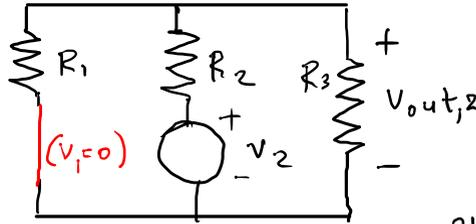
Για το πρώτο  $R_A = R_1$  και  $R_B = R_2 || R_3$
