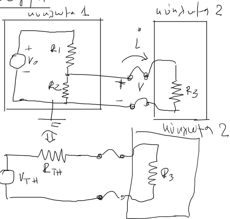
$$V = V_0 \cdot \frac{(R_2 // R_3)}{R_1 + (R_2 // R_3)}$$
