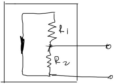
οπότε  $R_{TH} = R_1 // R_2 = \frac{R_1 R_2}{R_1 + R_2}$  δηλαδή το
