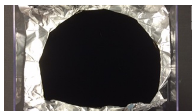
Εικόνα 2.4: Το υλικό Vantablack κατασκευασμένο από νανοσωλήνες άνθρακα (Surrey NanoSystems), το οποίο, κατά τους κατασκευαστές, απορροφά 99.96% του προσπίπτοντος σε αυτό φωτός. Εδώ, επάνω σε φύλλο αργιλίου.
